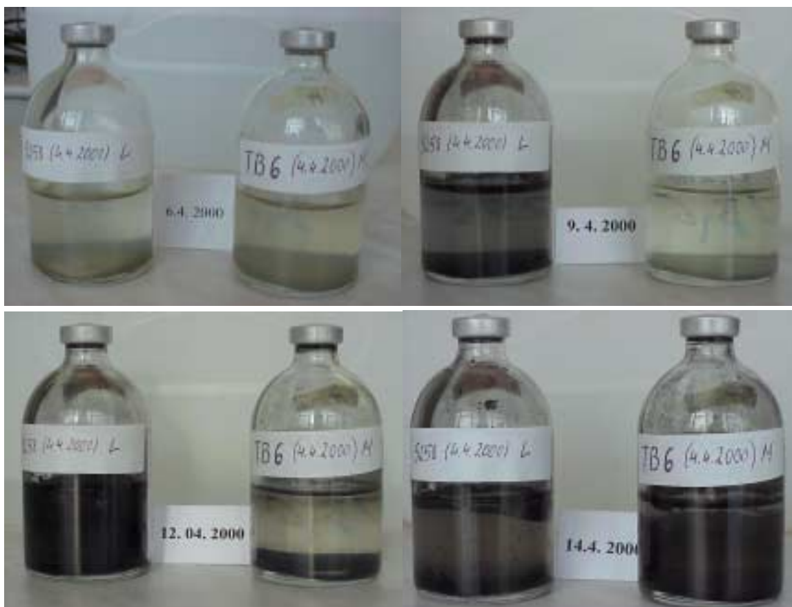
Abb.6.5.4 GWGM 5258 und TB 6 - Zeitlicher Verlauf der Sulfat-reduziererversuche
