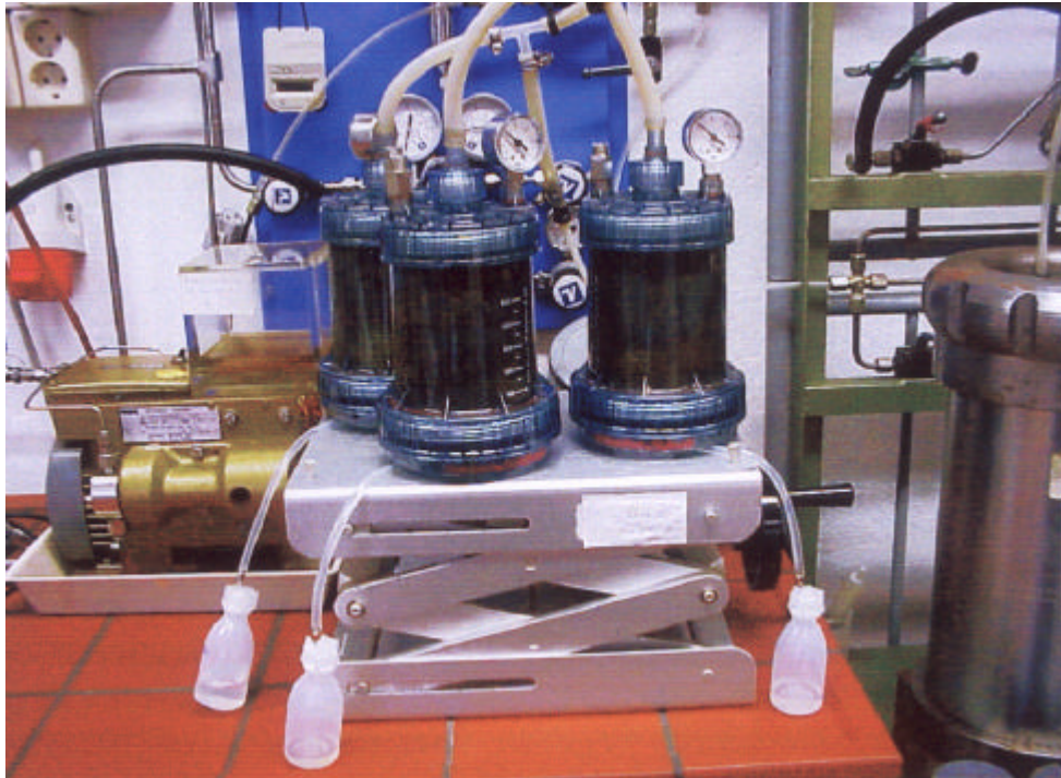
Abb.: Porenwassergewinnung mittels Stickstoffdruckfiltration
