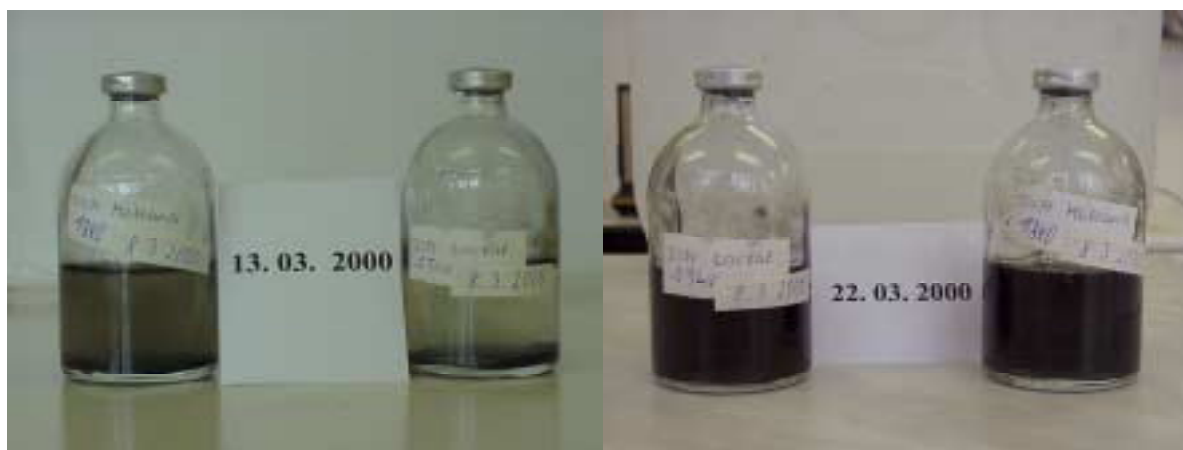
Abb. 7.3.3 Kippe Jänschwalde (GWGM 1340) - Zeitlicher Verlauf einfacher Flaschenversuche zur Aktivierbarkeit von Sulfatreduzierern
