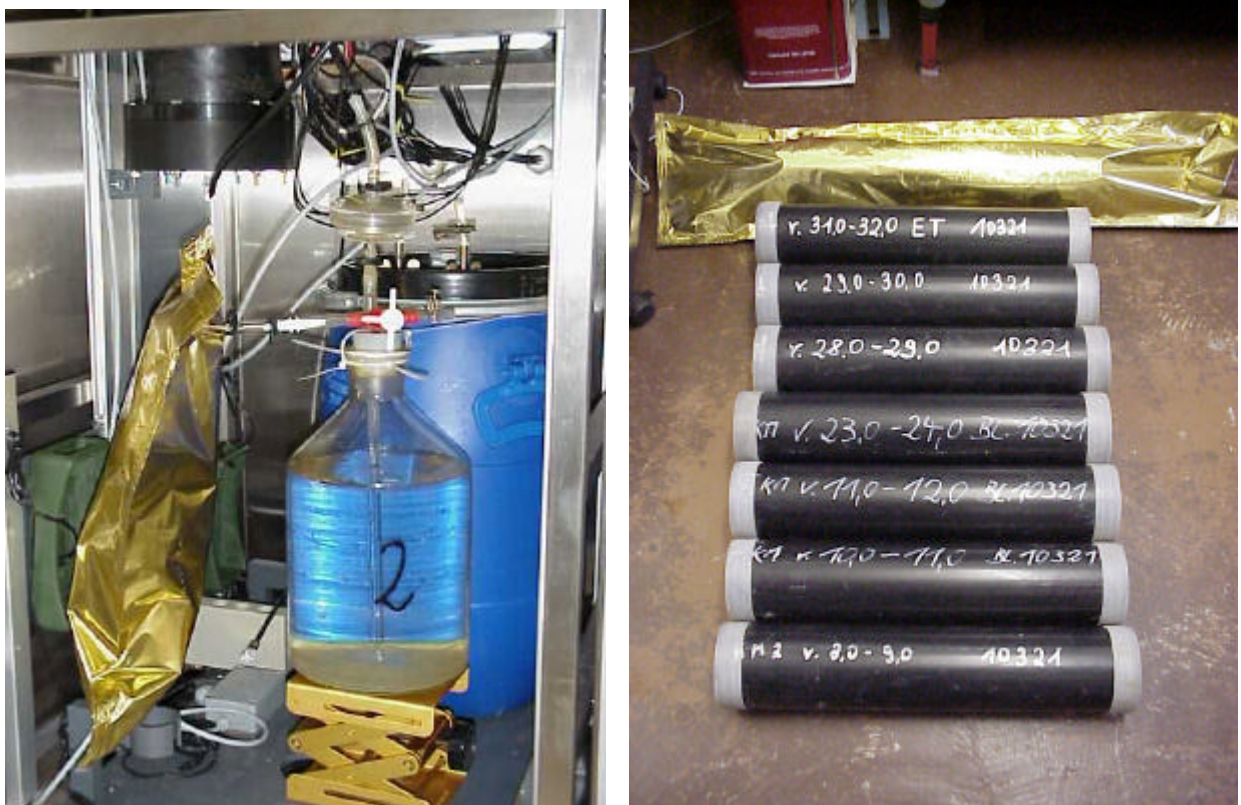
Abb.: Konservierung Kippenwasser-Infiltrat und Linermaterial
