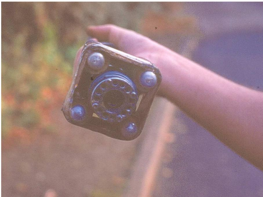
Abb. 3.2.4.4.3: Videokamera für die optische Kontrolle von Bohrlöchern und Grundwassermessstellen ab Ausbaudurchmesser DN 50
