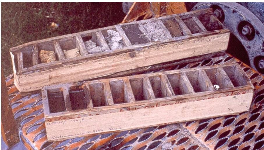
Abb. 3.2.2.2: Fächerkästen zum Transport von Bohrproben
