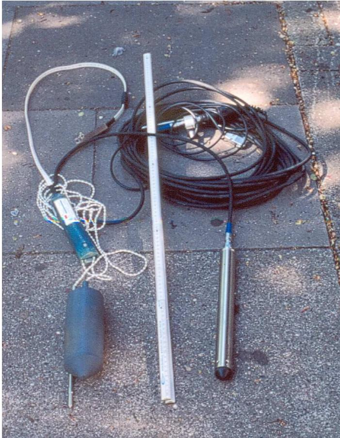
Abb. 4.3.3.2.4: Datensammler verschiedener Bauart. Links mit Schwimmermechanik ähnlich einem Pegelschreiber, rechts Drucksonde
