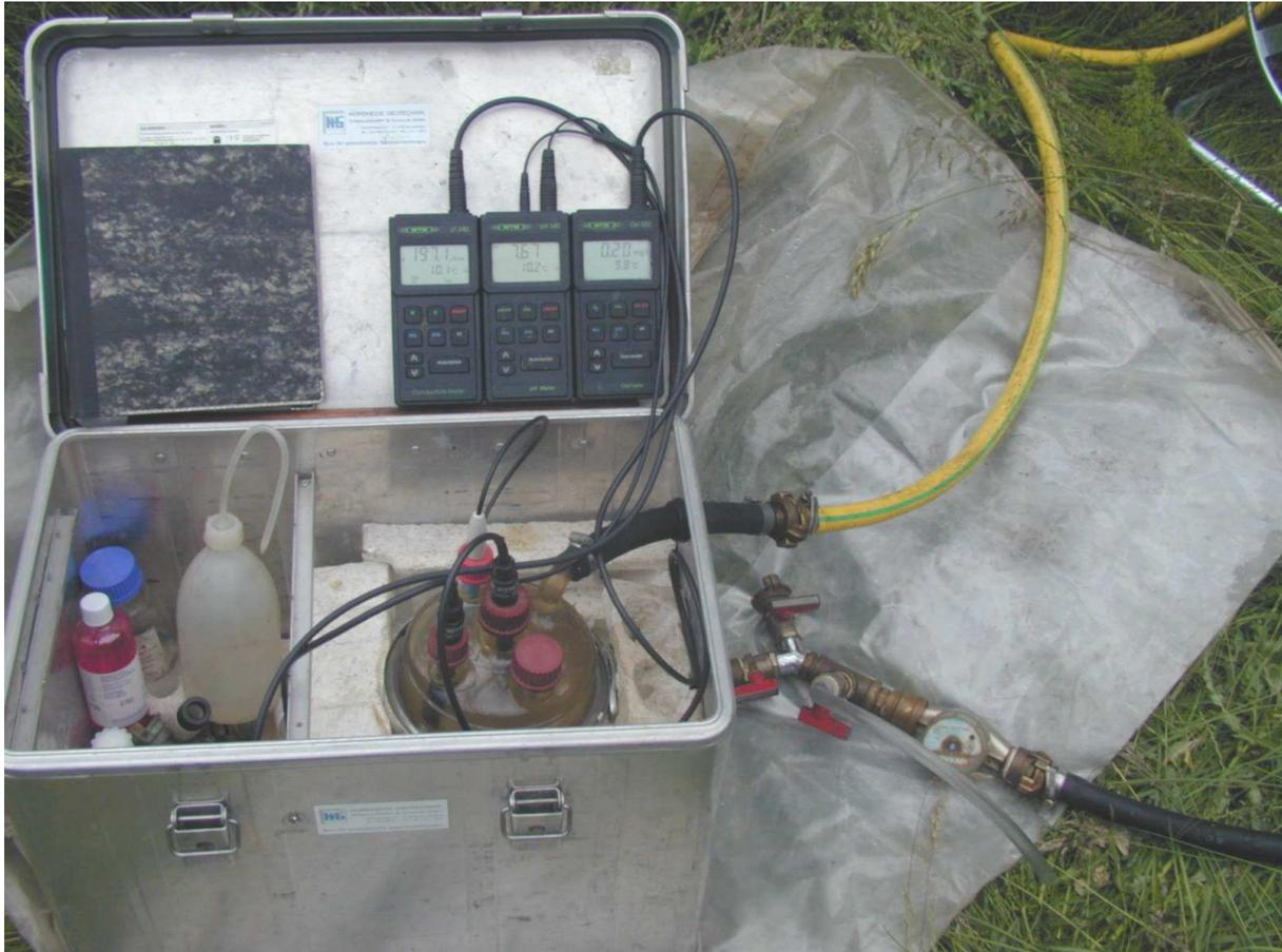
Abb. 6.1.9: Durchflussmesszelle zur Bestimmung physikalisch-chemischer Leitparameter (Foto: Nordheide Geotechnik GmbH)
