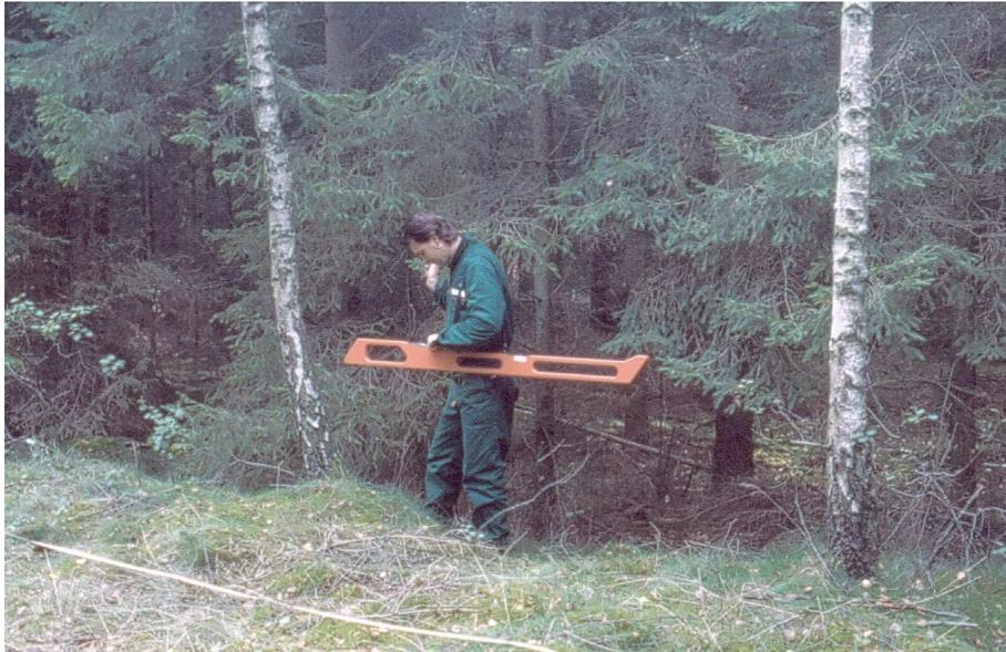
Abb. 3.3.4: Vermessungen nach dem Verfahren der elektromagnetischen Induktion
