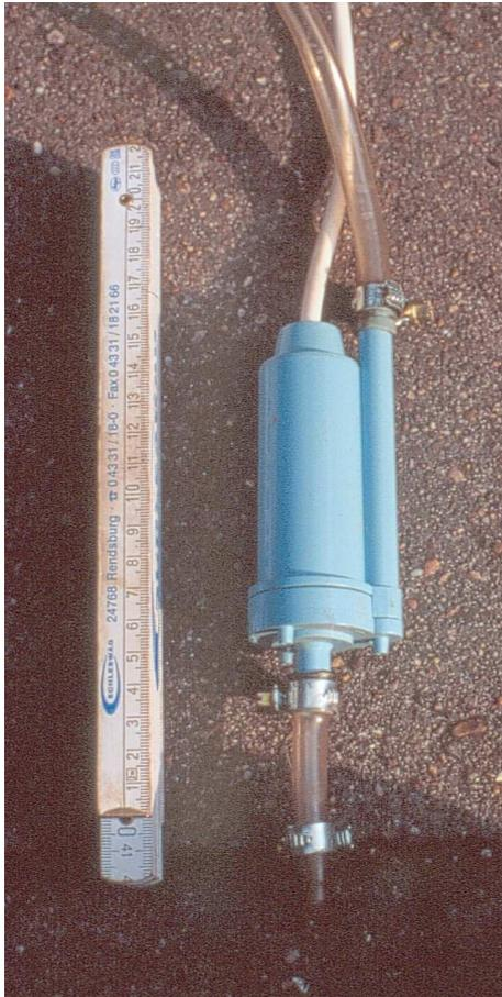
Abb. 6.1.5: Kleinunterwassermotorpumpe (sogenannte Campingpumpe)
