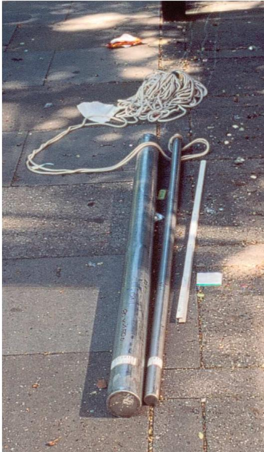
Abb. 4.1.4.2.2: Verdrängungskörper zur Durchführung von Slug- und Bail-Tests in Messstellen DN 100 – DN 125 und DN 50 – DN 65
