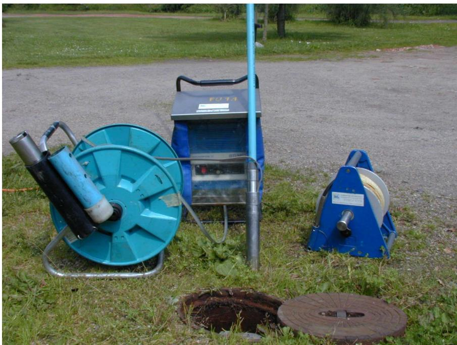
Abb. 6.1.4: Drehzahlgeregelte Unterwassermotorpumpe mit Steuerteil, Fabrikat Grundfos MP 1 (Foto: Nordheide Geotechnik GmbH)
