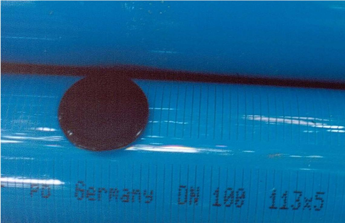
Abb. 5.2.1: Brunnenfilter aus PVC-U mit Schlitzlochung
