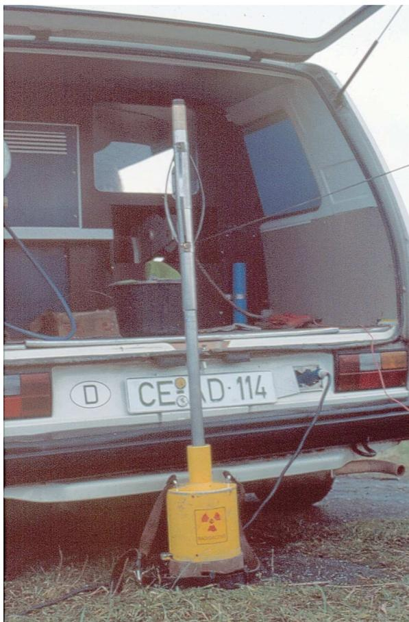
Abb. 3.2.4.3.1: Gamma-Gamma- (Dichte-) Sonde. Beachte die Abschirmung zum Schutz vor radioaktiver Strahlung.
