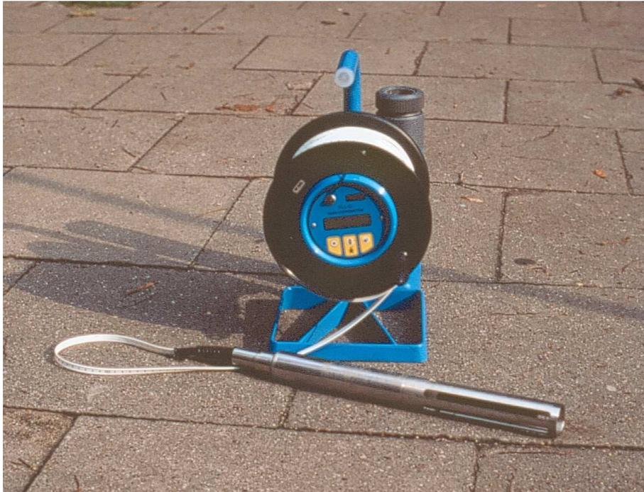
Abb. 3.2.4.1.1: Kabellichtlot zur Messung von elektrischer Leitfähigkeit und Temperatur
