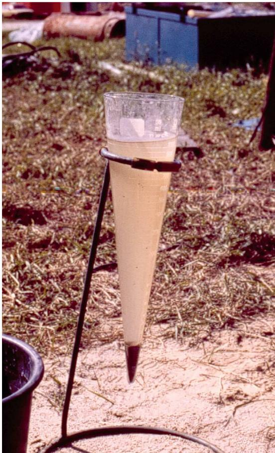
Abb. 5.3.3: Spitzglas zur volumetrischen Abschätzung des Sandgehaltes
