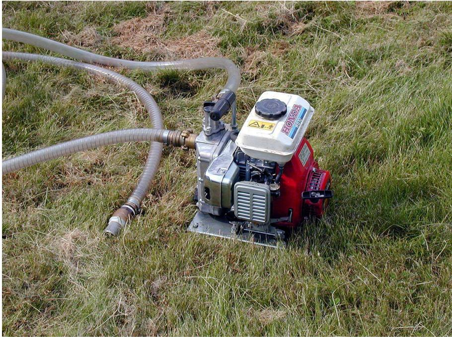
Abb. 6.1.1: Motorsaugpumpe (Foto: Dr. Reißner GmbH)
