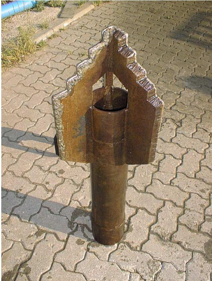
Abb. 3.2.1.14: Flügelmeißel für Druckspülbohrungen, effektiver Durchmesser 170 mm (Foto: Ivers Brunnenbau GmbH)
