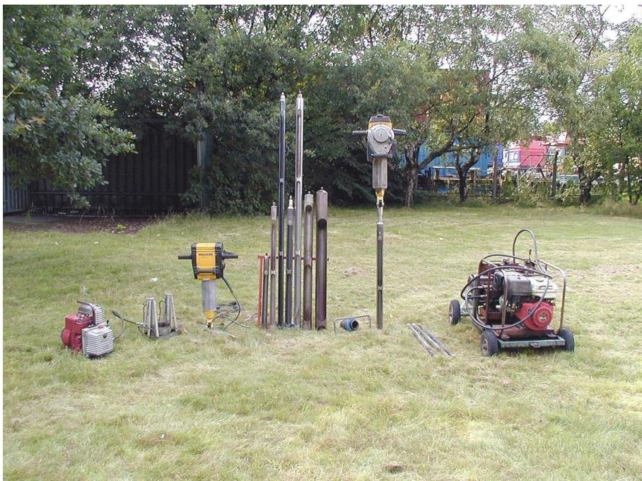
Abb. 3.2.1.1: Arbeitswerkzeuge für Schlitz- und Rammkernsondierungen (Foto: Dr. Beißner GmbH)
