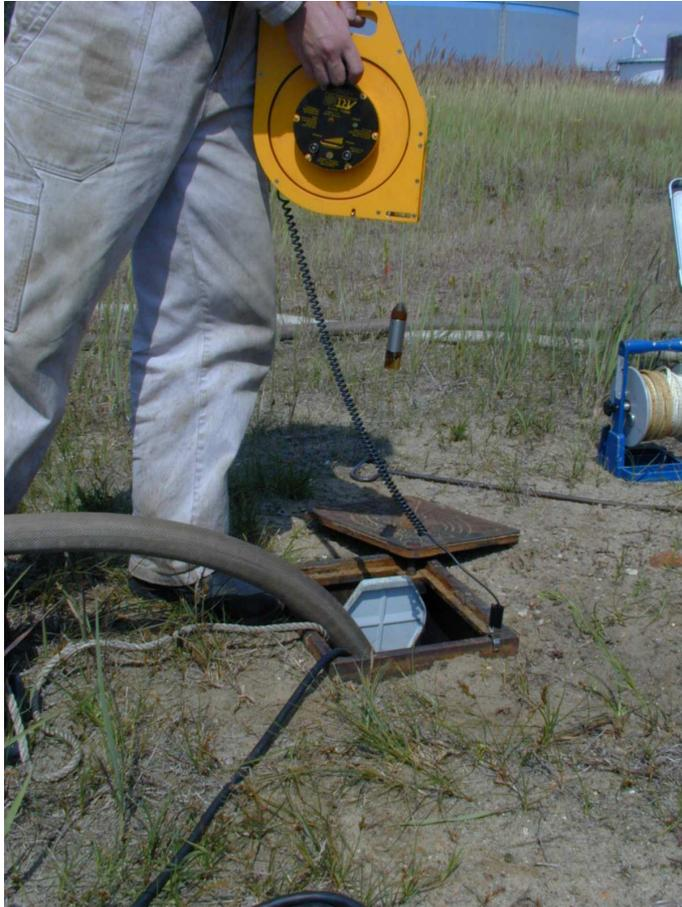
Abb. 4.3.3.2.2: 2-Phasen-Kabellichtlot (Foto: Nordheide Geotechnik GmbH)
