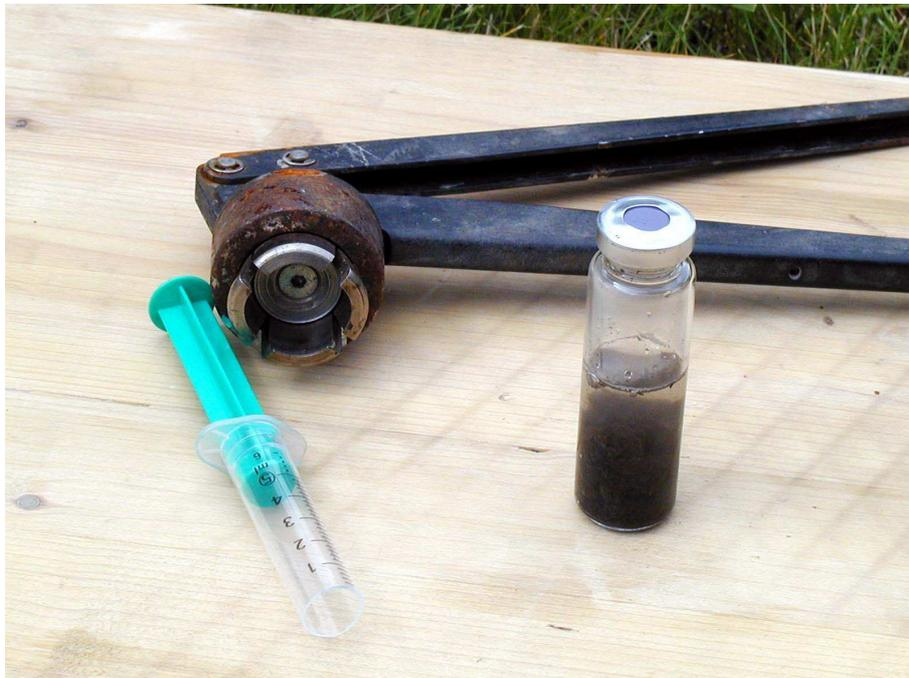
Abb. 3.2.2.4: Gasdicht schließendes Headspace-Glas und Zubehör zur Untersuchung auf leicht flüchtige Bestandteile (Foto: Dr. Beißner GmbH)
