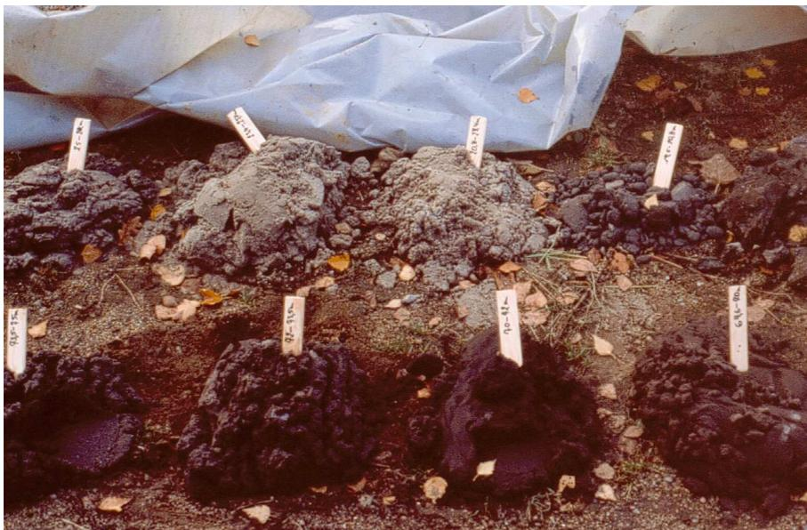
Abb. 3.2.2.1: Bohrproben ausgelegt zur Begutachtung durch die Fachbauleitung
