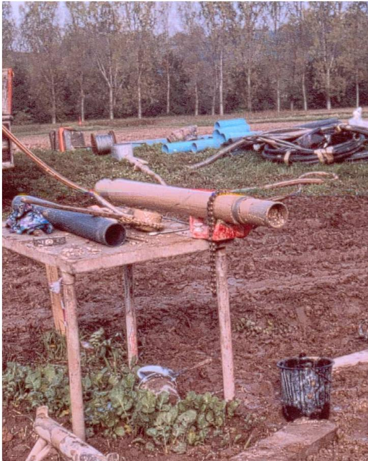
Abb. 3.2.2.5: Gerät zur Entnahme von Rammkernen aus Bohrungen zur hydrogeologischen Erkundung und Wassererschließung
