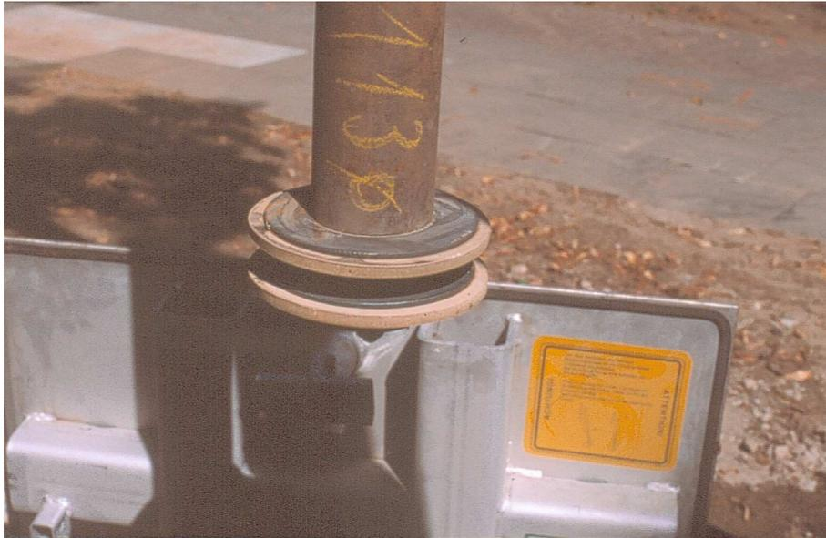
Abb. 5.3.1: Einfacher Entsandungskolben mit Manschetten aus Moosgummi zum Einsatz in Wickeldrahtfiltern
