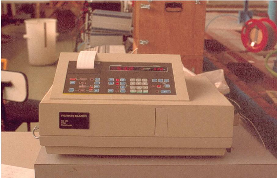
Abb. 4.3.3.4.2: Fluoreszenzmessgerät zur quantitativen Bestimmung von Markierungsmitteln, z. B. Uranin, im ppb- ( $\mu\text{g/l}$ -) Bereich
