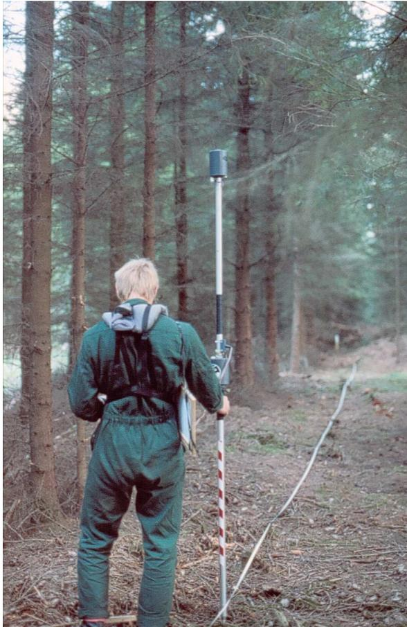
Abb. 3.3.6: Geomagnetische Vermessungen mittels Gradiometer (Magnetometer mit zwei Sonden in unterschiedlichem Abstand zur Geländeoberkante)
