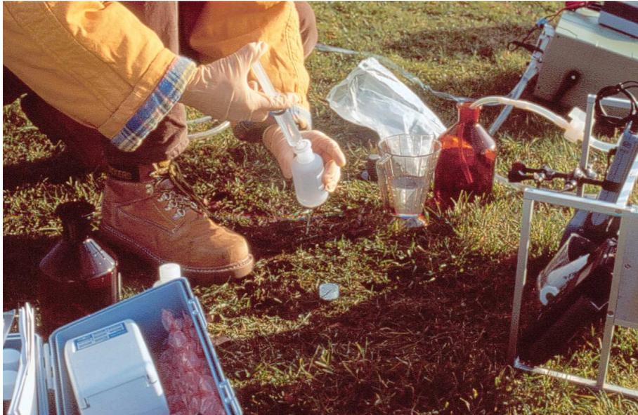
Abb. 6.1.8: Filtration einer Teilprobe für die Bestimmung von Schwermetallen
