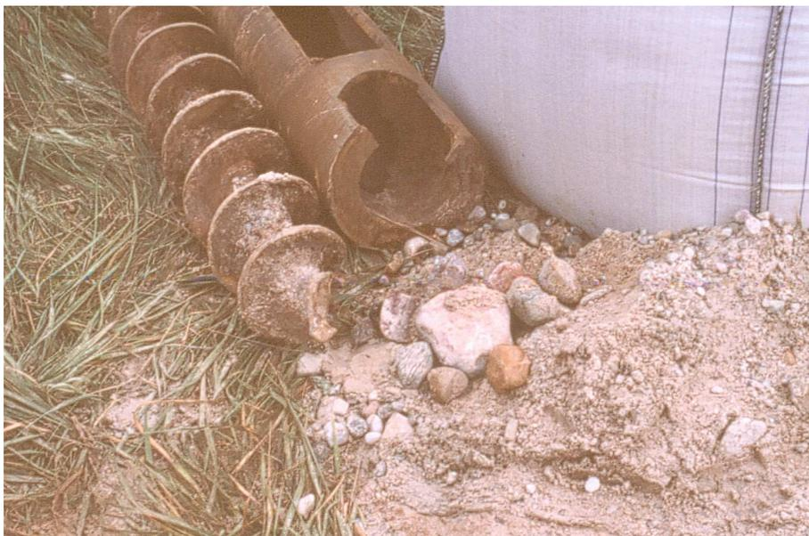
Abb. 3.2.1.5: Schnecke und Bohrschappe
