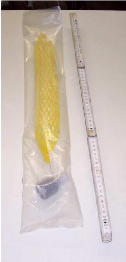
Abb. 6.1.7: Passive Diffusion Bag Sampler (PDBS) mit Diffusionsmembran aus Polyethylen (PE) (Innovative Messtechnik Weiß, Tübingen)
