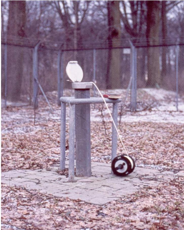
Abb. 3.2.3.2.6: Schutz einer Grundwassermessstelle durch Schutzrohr aus verzinktem Stahl und Dreieck aus Stahlrohr
