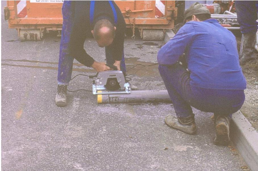
Abb. 3.2.2.6: Aufschneiden eines Rammkerns auf der Bohrstelle zur Entnahme von Proben zur chemischen Untersuchung
