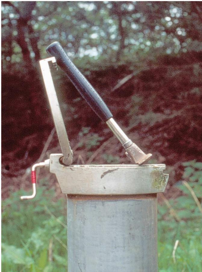
Abb. 3.2.3.2.8: Brunnenabschlusskappe ähnlich Werkstandard der Firma SEBA Hydrometrie GmbH
