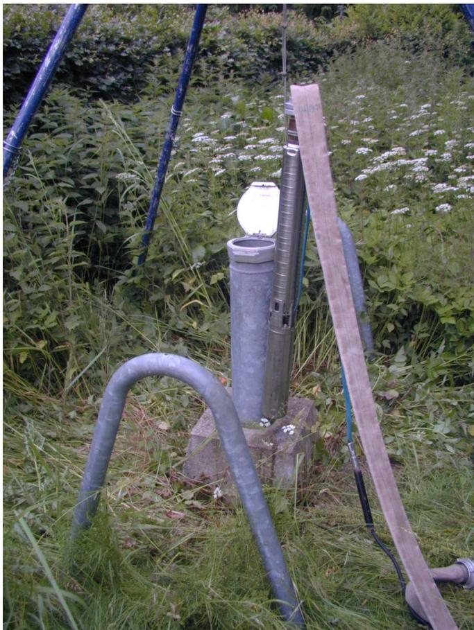
Abb. 6.1.3: Unterwassermotorpumpe für Probenahmen (Foto: Nordheide Geotechnik GmbH)
