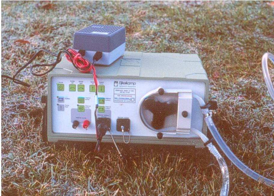
Abb. 6.1.2: Peristaltikpumpe für den Geländeeinsatz
