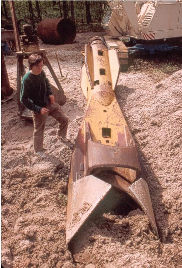
Abb. 3.2.1.6: Greifer für großkalibrige Trockenbohrungen (Foto: Th. Ptak)
