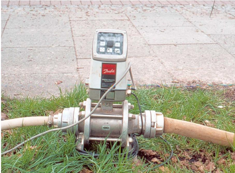
Abb. 4.1.4.1.1.1: Induktiver Durchflussmesser (IDM) zur kontinuierlichen Aufzeichnung der Förderrate während eines Pumpversuchs
