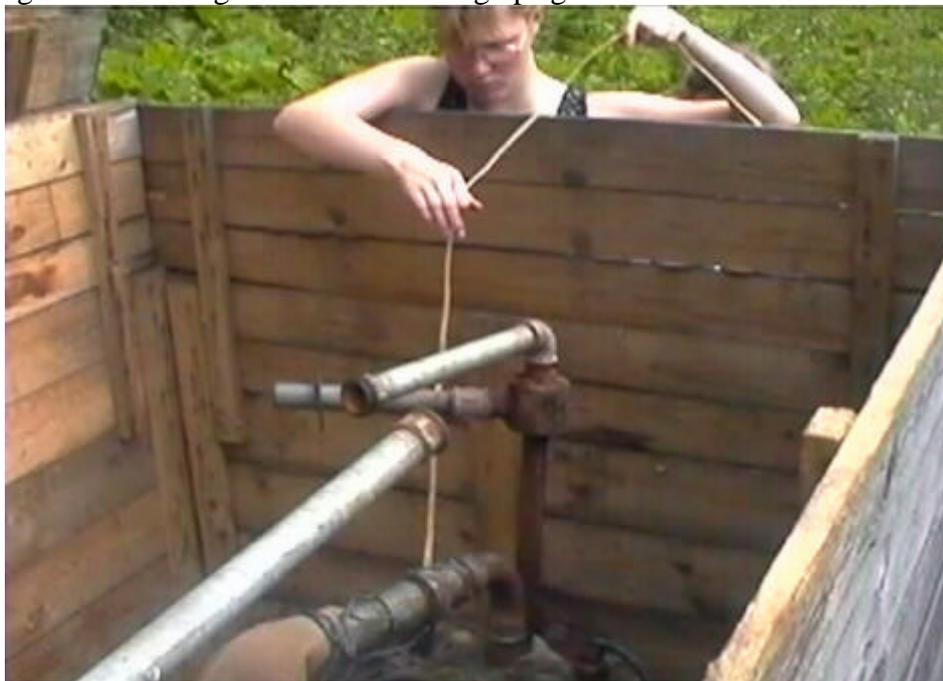
• Abb 67: Studentin bei der Messung des Grundwasserspiegels im Brunnen während des Pumpversuches.
