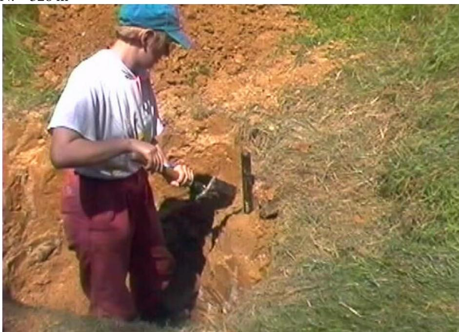
• Abb 41/2: Bergung der Sonde der Rammkernsondierung.
