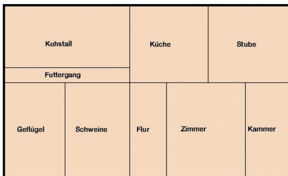
Schematischer, nicht maßstabgerechter Grundriss einer Häuslerei Schematic ground plan, not to scale, of a smallholding (Häuslerei)
