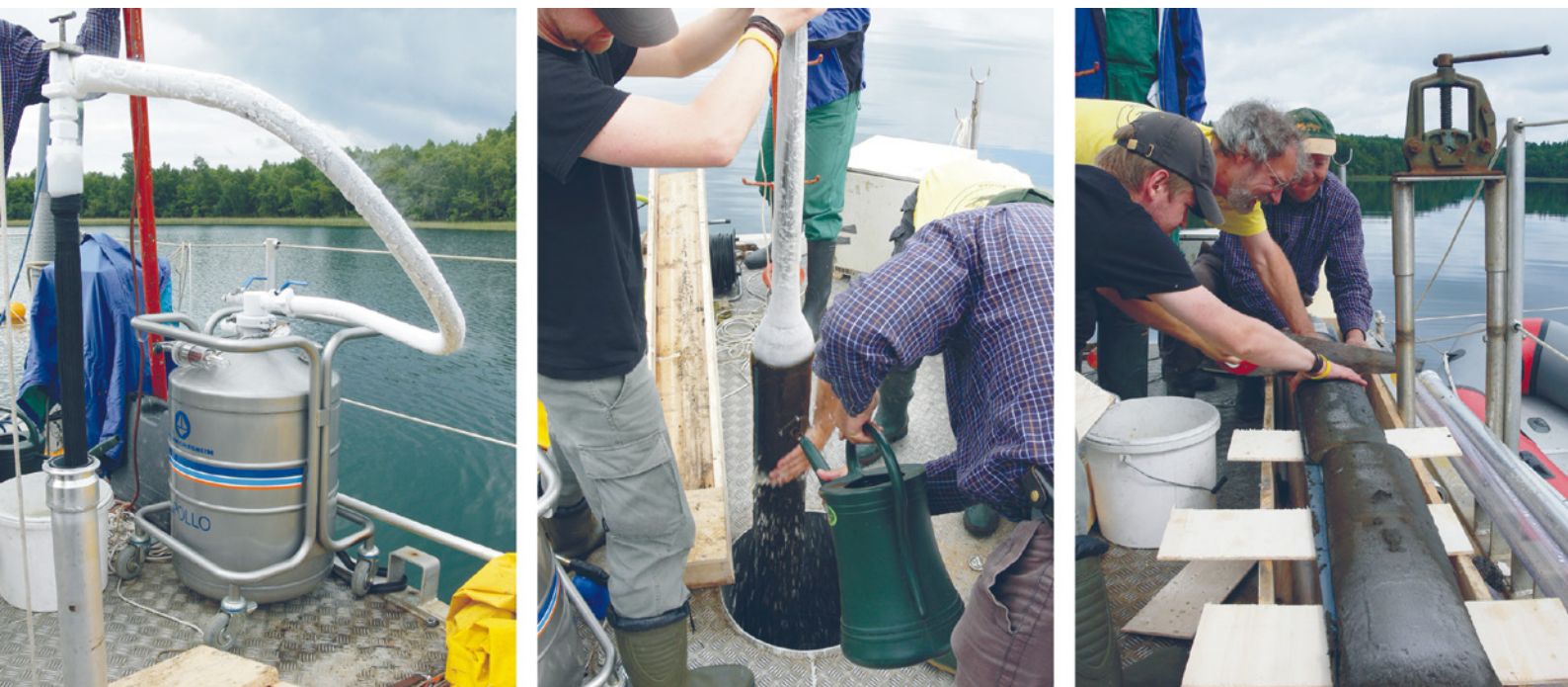
Abb. 5: Seebohrungen von nicht konsolidierten Seesedimenten mit Hilfe von Gefriertechnik. Ein Bohr-Schwert wird in das Sediment getrieben und dann mit flüssigem Stickstoff gefüllt (links). Nach Anfrieren des Sediments am Schwert wird der Gefrierkern anschließend geborgen (mittig) und in Einzelsegmente zerteilt (rechts, Fotos: Hinrich Meyer).
