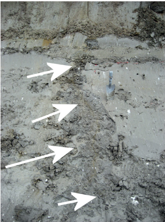
Abb. 7: Wandaufsicht mit Frost-/Eiskeilstruktur, bzw. glazitektonischer Kluft an der Ostseite des Aufschlusses, maximal wenige cm breit. Farbänderung im umgebenden Till (braune Farbe). Kelle als Maßstab (ca. 25 cm) in abgeschrägter Aufschlusswand.
