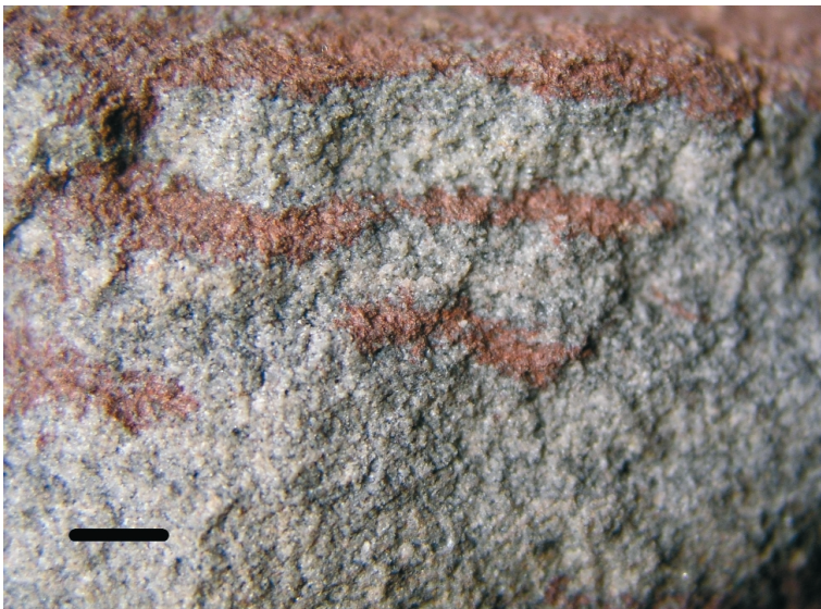
Abb. 5: Sandstein der unteren Schleiden-Formation mit geröteten Tonlaminae, Balken = 5 mm.
