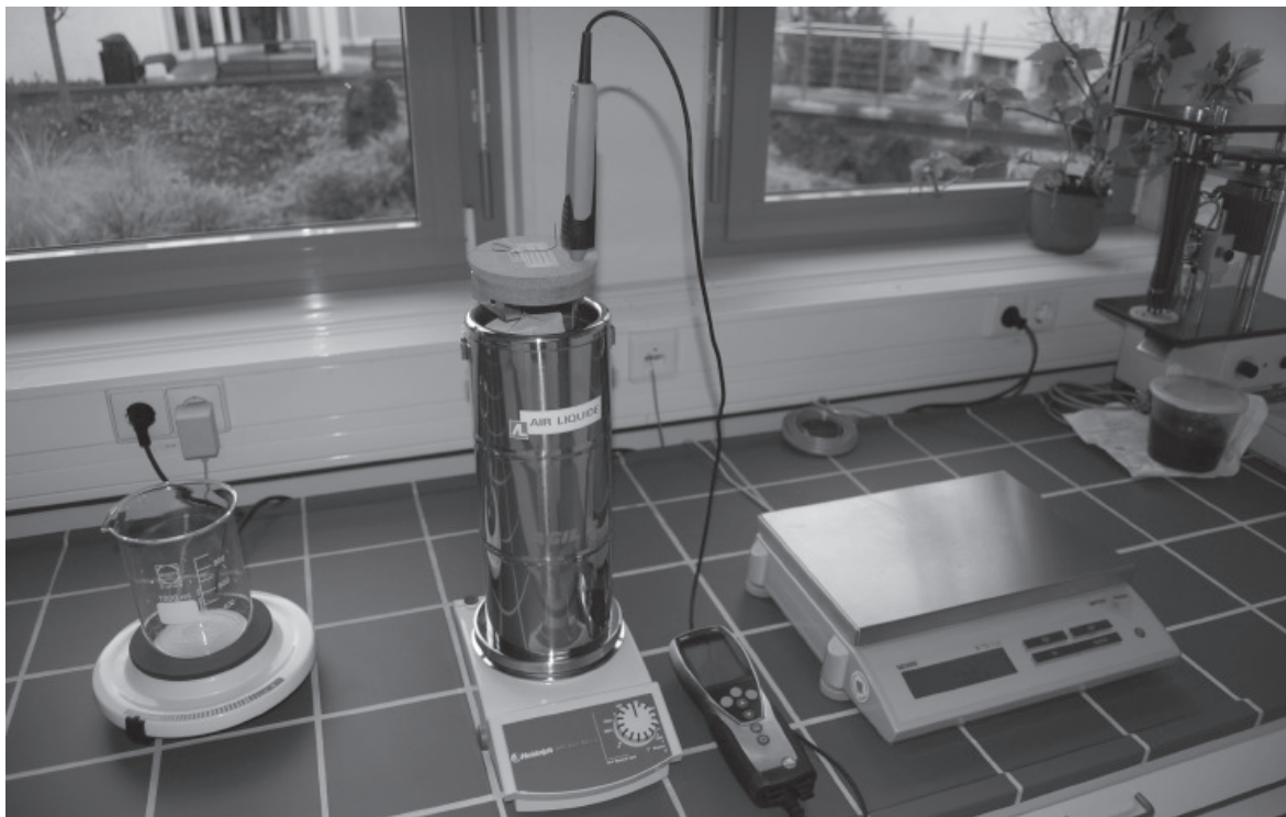
Abb. 2: Versuchsaufbau zur Messung der spezifischen Wärmekapazität von Festgesteinsproben bzw. des Wasserwertes. Von links nach rechts: Wärmeplatte mit Becherglas, Dewargefäß mit Korkdeckel und Temperaturmess Einheit auf Magnetrührer stehend, Waage.
