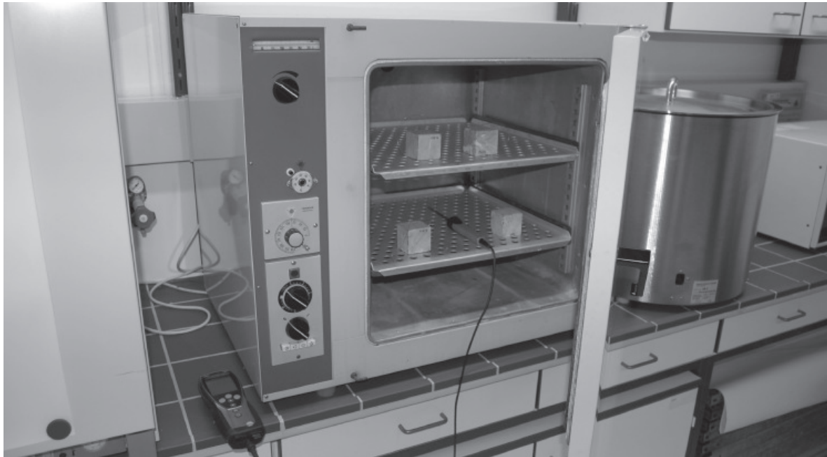
Abb. 1: Trockenofen für die Aufheizung der Gesteinsproben mit Temperaturmessfühler und Temperaturmessgerät.
