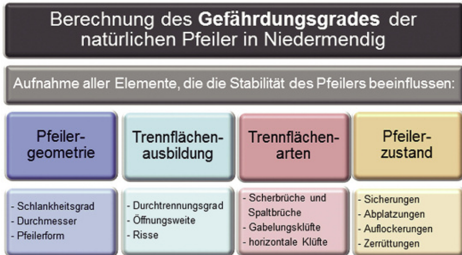
Abb. 8: Einflussstypen zur Berechnung des Gefahrengades eines untertägigen Pfeilers in Niedermendig. Die Vergabe der Bewertungspunkte beruht auf den stabilitätserhaltenden und stabilitätsmindernden Faktoren der Pfeiler.
