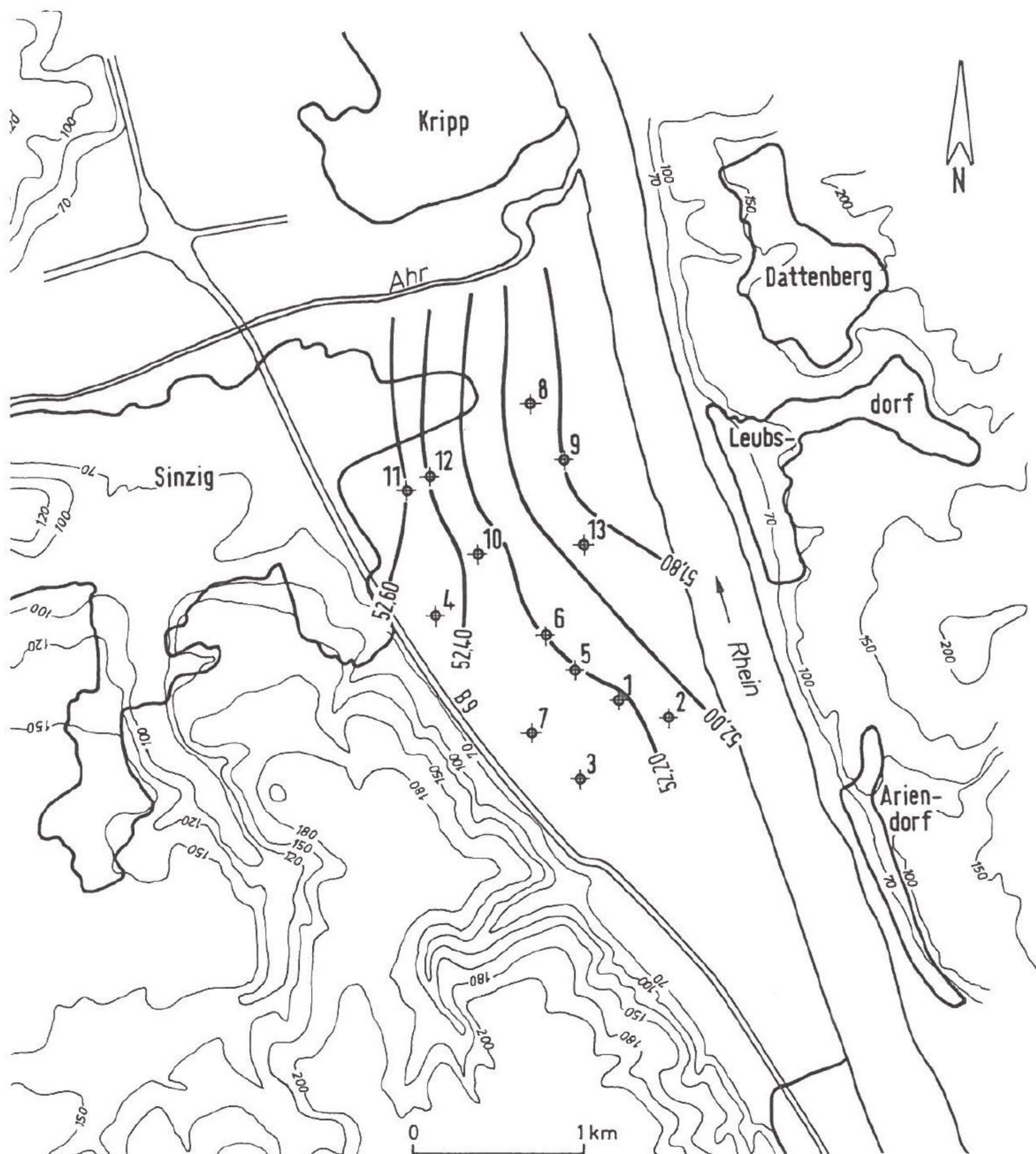
Abb. 3b: Grundwassergleichenplan (Stichtagsmessung 09.11. 1994).
