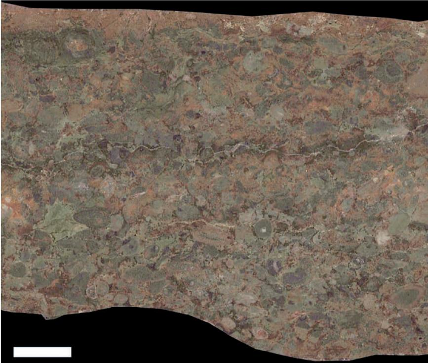
Abb. 15: Aufschluss 23, Lagerplatz, Kalksiltit bis siltiger Packstone, orientierter Anschliff: graue gerundete Kalkkrusten und Karbonat-Konkretionen (Caliche sensu MÖHRING & SCHÄFER 1990) sowie grün-graue Siltklasten in rotbrauner siltig-karbonatischer Matrix; Foto unter Wasserbedeckung, Maßstabsbalken = 1 cm. (NHMM/LS G 2020/5009-LS)
