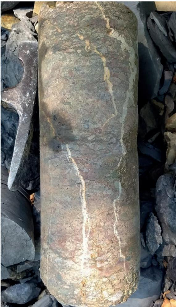
Abb. 16: Aufschluss 23, Bohrung S02, Teufe ca. 500 bis 600 cm: Anreicherung von bunten Zentimeter-großen Karbonat-Konkretionen (Caliche) in siltiger Matrix; Bohrkerndurchmesser = 10 cm.
