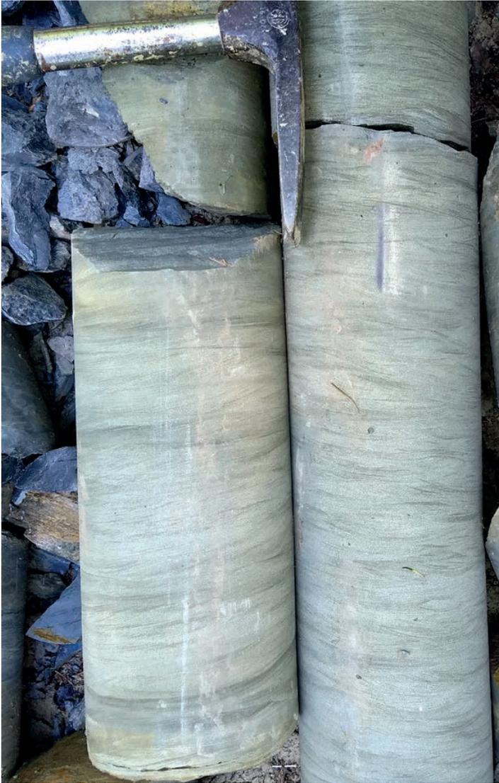
Abb. 6: Aufschluss 19, Bohrung S06, Tiefe ca. 2.200 bis 2.400 cm: mehrere Meter mächtiger Feinsandstein mit Rippel-Sets im Zentimeter-Abstand; Bohrkerndurchmesser = 10 cm.
