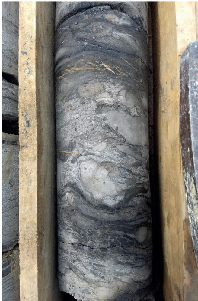
Abb. 17: Aufschluss 9, Bohrung S07, Teufe 1060 cm: Anreicherung von grauen und braunen Zentimeter-großen Karbonat-Konkretionen (Caliche) sowie Ton-Klasten in sandiger Matrix; Bohrkerndurchmesser = 10 cm.
