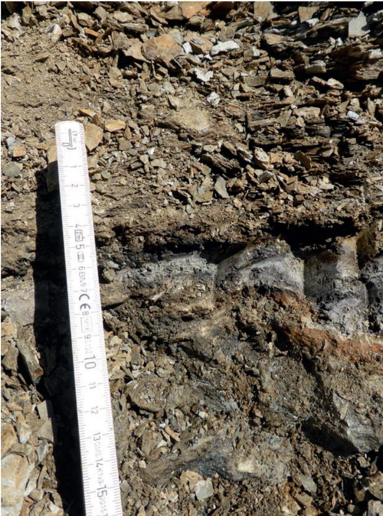
Abb. 23: Aufschluss 19, Fundamentgrube, Profil Schicht 2: siltig-feinsandige vulkanische Asche mit brauner limonitischer Basis, überlagert von laminiertem Tonstein (Profil Schicht 3, „unterer Tonstein“); sichtbarer Maßstab = 18 cm.
