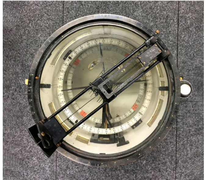
Abb. 3: Doppelkompass. Die Abbildungen entstammen dem Archiv des Observatoriums Potsdam/Niemegk. Sie zeigen eine spätere Version des Instruments der Firma Askania: links: Gesamtansicht, rechts: Doppelkompass von oben. Deutlich erkennt man die beiden übereinander angeordneten Kompassrosen (Quelle: Archiv des Observatoriums Potsdam/Niemegk).
