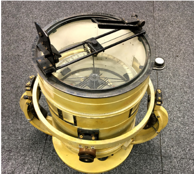
Abb. 3: Doppelkompass. Die Abbildungen entstammen dem Archiv des Observatoriums Potsdam/Niemegk. Sie zeigen eine spätere Version des Instruments der Firma Askania: links: Gesamtansicht, rechts: Doppelkompass von oben. Deutlich erkennt man die beiden übereinander angeordneten Kompassrosen (Quelle: Archiv des Observatoriums Potsdam/Niemegk).
