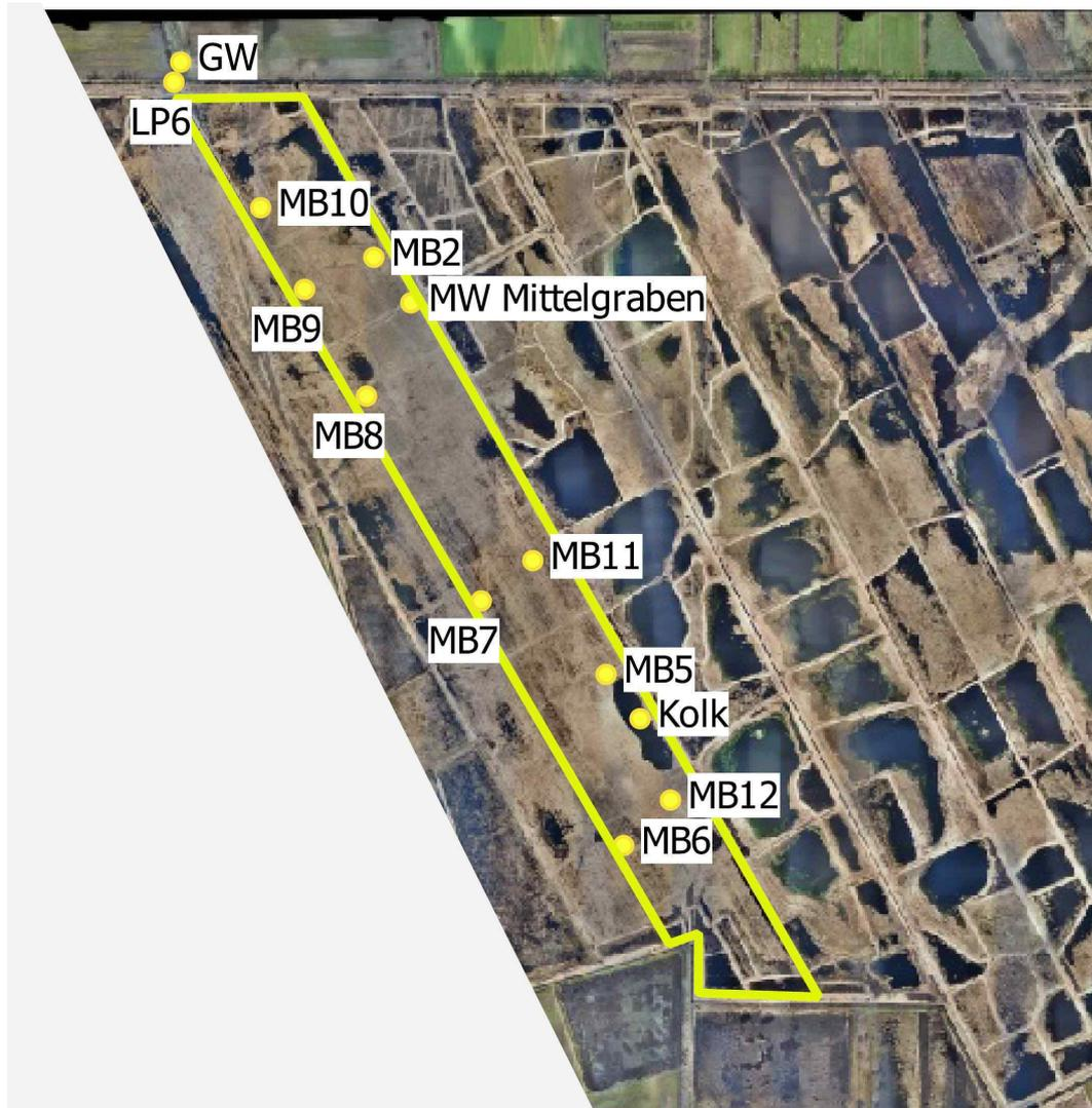
**Abb. B: Lageplan der Projektfläche (gelbe Umrandung) mit Messstellen zur Erfassung der Wasserstände.**
