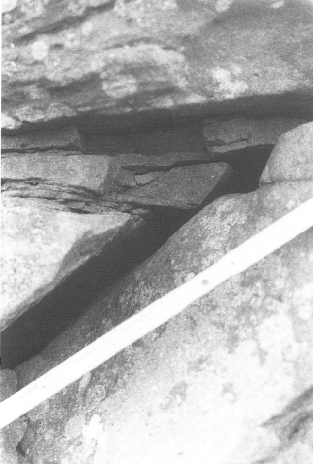
Abb. 7: Detailansicht einer Bewegungsfuge mit deutlichem Versatzbetrag im oberen Teil des absturzgefährdeten Felsblockes (Foto HÄFNER 13. 9. 1990).
