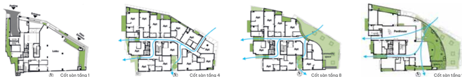
Hình 10.6. Tòa nhà được thiết kế thông gió tự nhiên (Nguồn: Văn phòng Kiến trúc 1+1>2)
