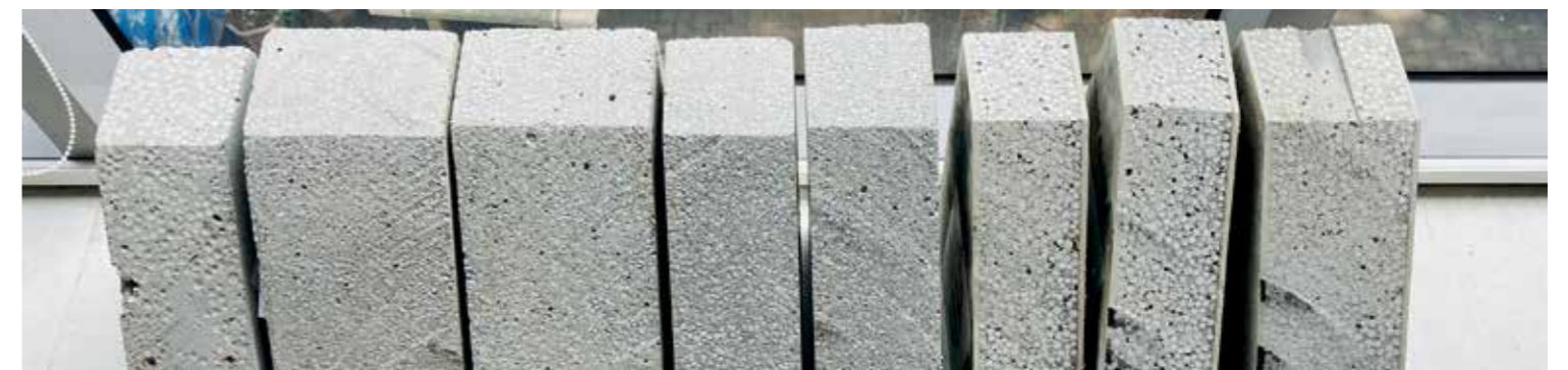
Hình 5.3. Phát triển tấm tường panel bê tông nhẹ bọt xốp EPS NUCEWALL tại Trường Đại học Xây dựng Hà Nội (Nguồn: Andreas Zegowitz)
