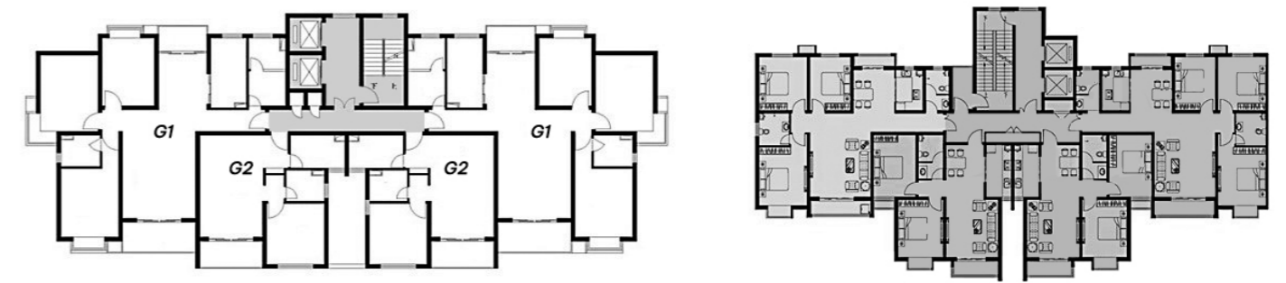
Hình 2.9. Sơ đồ mặt bằng tòa nhà 16 tầng (2008) (trái) và tòa nhà 24 tầng (2012) để tham khảo (Nguồn: Li Zhenyu, 2009).
