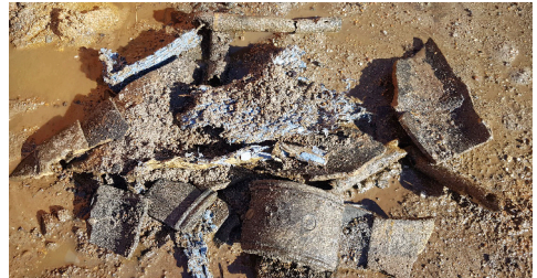
Abb. 11: Kugelgreifer zur Bohrgutbergung in der Bohrrtour (linkes Bild) und Bruchstücke des Gussrohrausbaus (rechtes Bild) sowie Reste der Stahlinschubverrohrung (Fotos: C. Treskatis)
