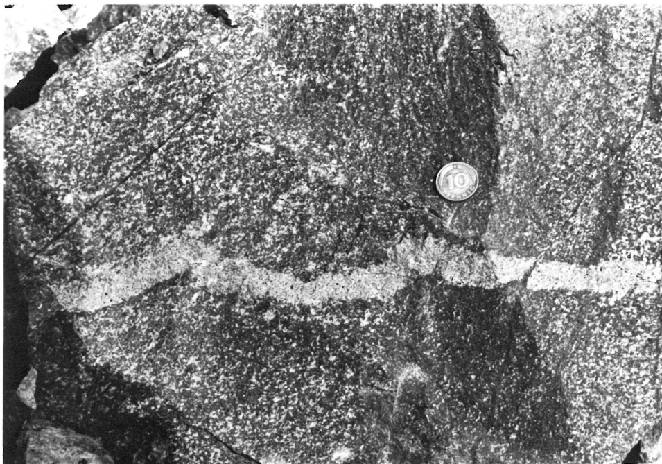
Abb. 4: Helles Gängchen der latitischen Restphase als Füllung einer Kontraktionskluft, Vorkommen Wasenbach.
