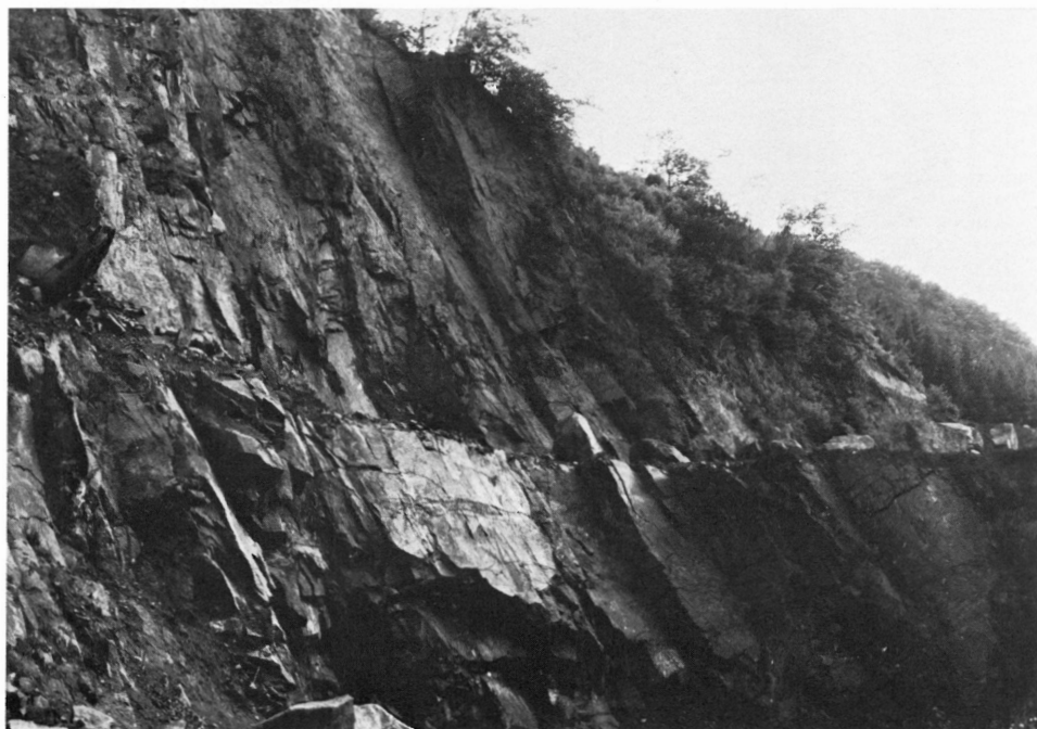
Abb. 3: Grobsäulige Absonderung im Vorkommen Wasenbach, südlicher Steinbruch (s. Abb. 2). Höhe der unteren Strosse ca. 10 m.
