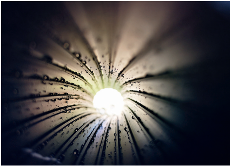
Abb. 6: Rippen an der Innenwandung eines EWS-Rohres zur Erreichung einer quasi-turbulenten Strömung des Wärmeträgermittels (Foto: S. Rumohr)
