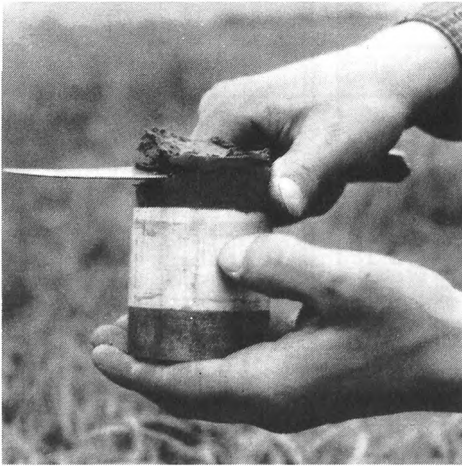
Abb. 5/3 Präparierung einer Stechzylinderprobe nach der Entnahme
