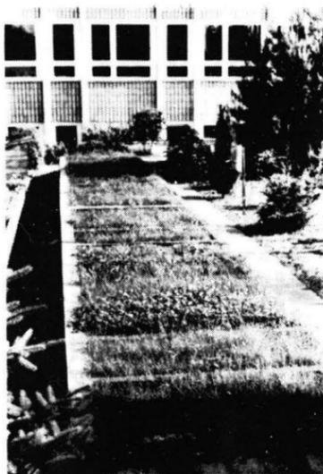
Wie auf dem Photo zu erkennen ist, enden die Kästen in einem tiefer liegenden Laufgang. Jeder Lysimeter besitzt am Boden 2 Ausläufe. Der eine ist für die Aufnahme eines Schauröhrchens bestimmt, um den Grundwasserstand zu ermitteln, der andere ist mit einem Hahn versehen und dient zur Entnahme von Sickerwasser. Alle Kästen haben wir für die Beschlämmung fol-
