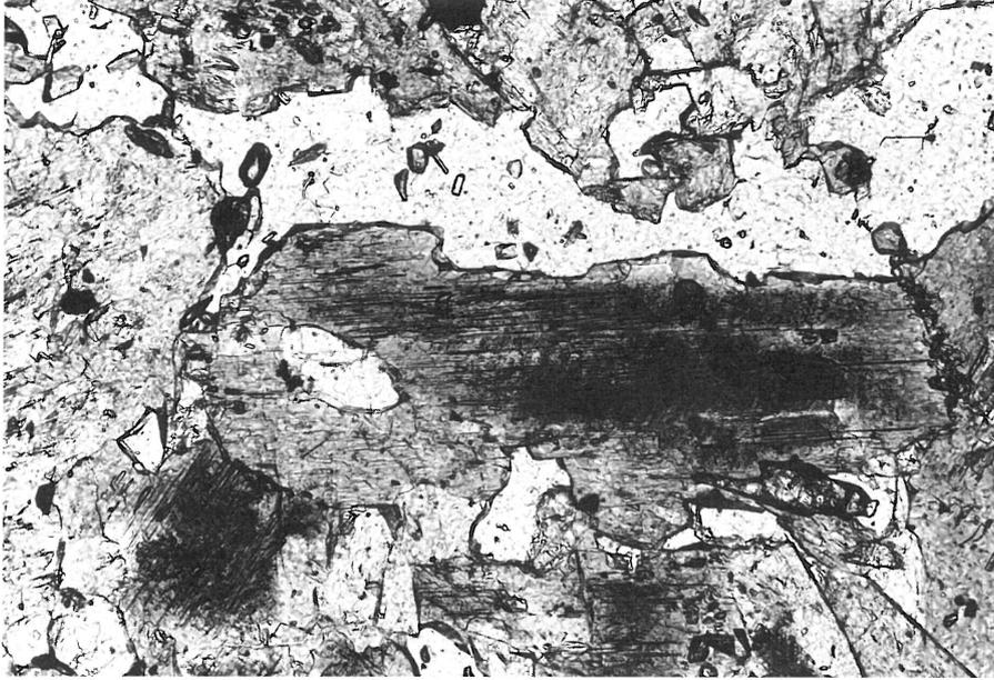
Abb. 4a: Präalpine braune Hornblende mit Ilmenit-Einschlüssen, umwachsen von grüner alpiner Hornblende mit Plagioklas- und Titanit-Einschlüssen. Hornblendens werden von Plagioklas begrenzt. Probe Al 169, gekreuzte Nicols, Längsseite entspricht 0,88 mm.
