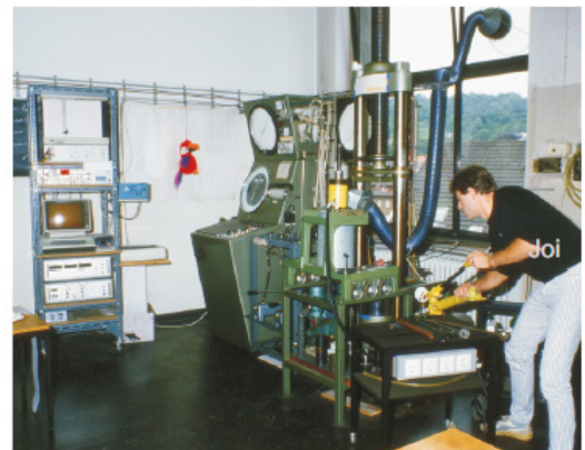
2. Aachener Verformungsapparatur in Betrieb bis etwa 1994, ermöglichte Verformungsversuche bis ca. 450°C und variablen Verformungsraten mit digitaler Datenerfassung durch einen Apple PC.
