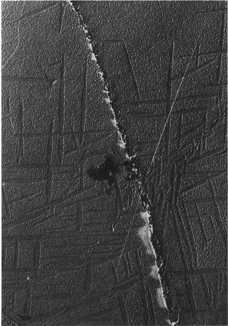
Abb. 2: Titanomagnetitkorn im Basalt des Rauhen Kulm. Thermische Vorbehandlung: 12 h auf 1000°C erhitzt. Lamellen von Ilmenit und Hämatit. Grundmasse ist entmischter Magnetit. Tyloseabdruck. Elektronenmikroskopische Vergr.: 20000 mal. (2 cm in der Abbildung entsprechen 1 \mu in der Natur).
