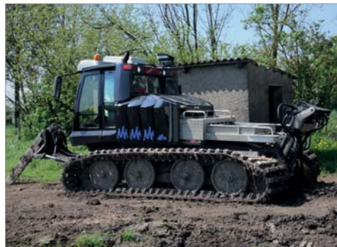
Abb. 13: Pistenraupe mit Reißzahn zum Zerstören der Tondränagen Slope groomer with grubber to destroy the clay drainpipes
