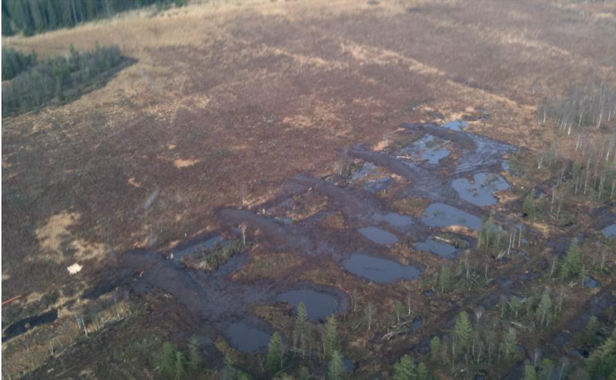
Abb. 4: Wiedervernässungsmaßnahme im Hochmoor Mecklenbruch/Solling durch den Bau von fünf Torfdämmen in einem alten Torfstich mit angrenzenden, wassergefüllten Torfentnahmestellen.
