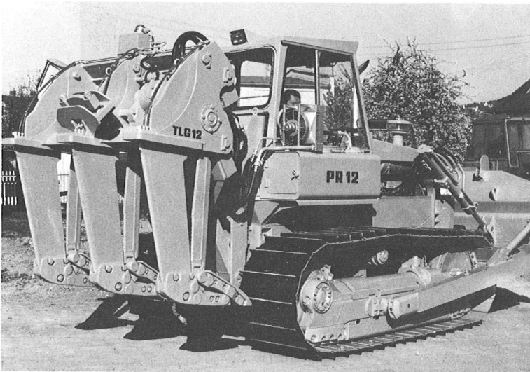
Bild 9.19 Stech-Hub-Tieflockerer mit Dreischarsystem der Fa. Kaebler-Gmeiner (Typ TLG 12), Arbeitstiefe bis rd. 1 m
