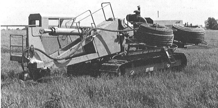
Bild 9.12 Grabenfreie Dränmaschine der Fa. Mehrings beim Verlegen von Vollfilter-Dränrohren
