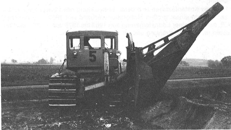
Bild 9.21 Tiefkulturpflug am Traktor der Fa. Ottomeyer, max. Arbeitstiefe 1,6 m
