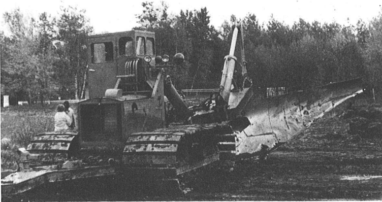
Bild 9.20 Tiefkulturpflug auf eigener Raupe der Fa. Ottomeyer, max. Arbeitstiefe 2,4 m
