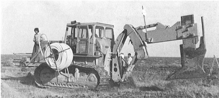
Bild 9.11 Grabenfreie Dränmaschine der Fa. Cornelius, die PVC-Dränrohre im Gefälle verlegt
