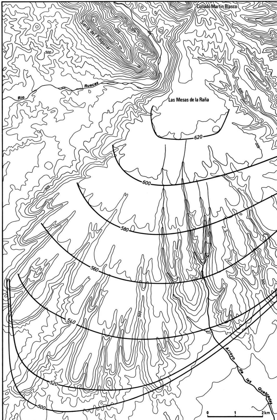
Abb. 16 Schüttungskegel vor der Talpforte des Rio Rucas. Die Isohypsen stellen die Enveloppe (Hüllfläche) der Rañas dar. Der Kegel ist asymmetrisch, da der Transportvorgang nach Osten durch einen Quarzithärding abgeblockt wurde.
