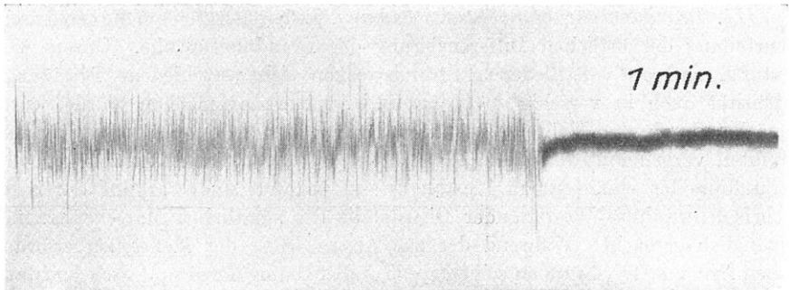
Fig. 8. Bodenunruhe auf dem Südflügel der Insel Sylt während der Schienenauto-Meßfahrt, 14./15. April 1938, Meßpunkt 6 in 325 m Küstenabstand. Böen selten. 1.1 mm Ausschlagweite entspricht 2 \cdot 10^{-8} cm Bodenamplitude (bei 50 Hz)
