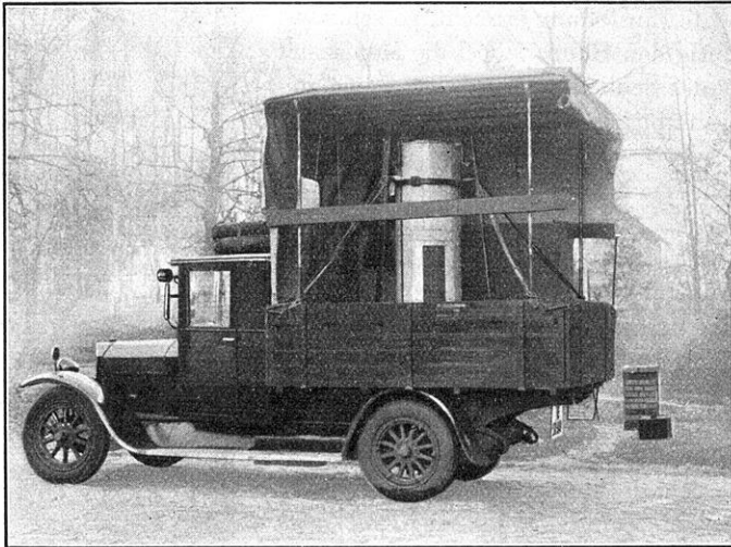
Fig. 8. Statischer Schweremesser in meßfertigem Zustande
