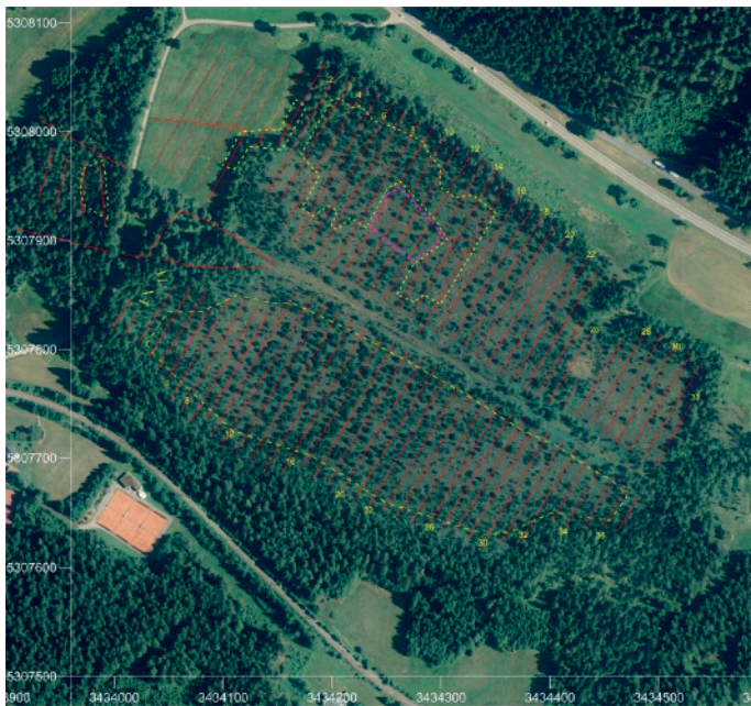
Abb. 3: Wiedervernässung im Ostmoor Hinterzarten (gelb gestrichelte Flächen = Gräben durch Kammerung verschlossen. Die gelben Balken am westlichen Randgehänge nahe des Neuweltweges markieren die Lage größerer Sperrern in Torfstichen. Fläche Nordteil (ohne die Insel am Neuweltweg und den Übergang ins Niedermoos) 1,34 ha, Südteil 4,48 ha. Rosa umrandete Fläche = Gräben bereits 2008 verschlossen; Quelle: Abschlussbericht Hinterzartener Moor BÖG 2016, Bereich ausgeschnitten; Datengrundlage: Geobasisdaten © Landesamt für Geoinformation und Landentwicklung Baden-Württemberg, www.lgl-bw.de , Az 2851-1/19). Rewetting implemented in the eastern part of the project area Hinterzartener Moor
