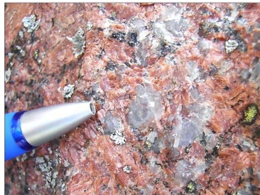
Abb. G1.2: Quarz-Phänokristen im grobkörnigen Götömar-Granit; eine Wachstumszonierung wird durch Zonen unterschiedlicher Trübung abgebildet.
