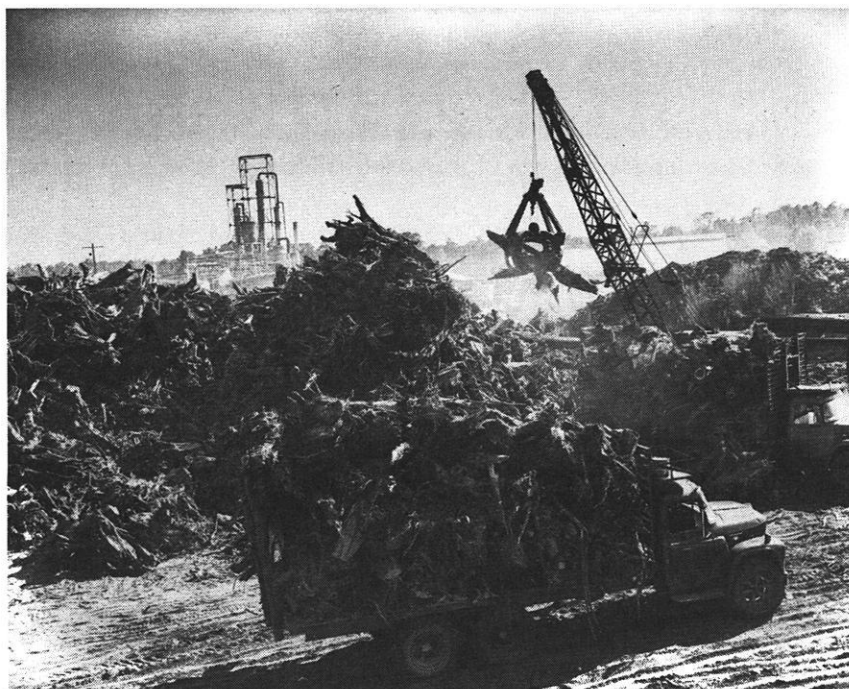
Abb. 16: Baumstümpfe zur Terpentindestillation Abladen der Baumstümpfe vor einer Terpentinfabrik (Continental Turpentine) in Cross City, Florida (Aufnahme: U.S. Forest Service)
