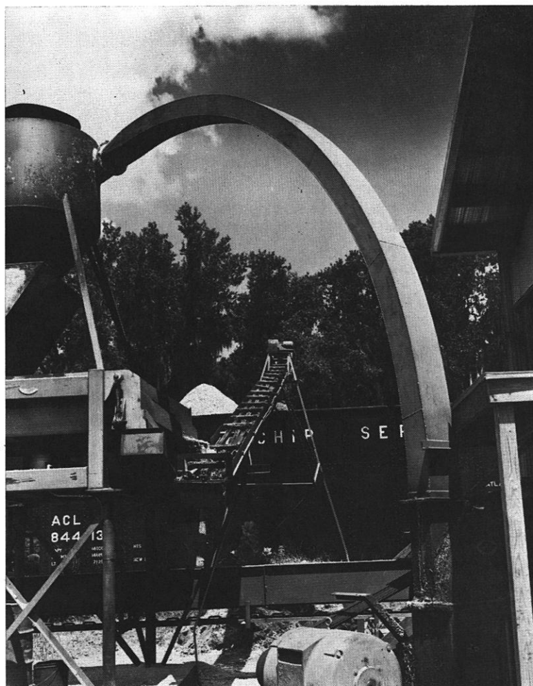
Abb. 27: Verladen von Holzabfällen einer Sägemühle. Das Bild zeigt im Vordergrund die Absaugvorrichtung für die Holzspäne sowie Sägemehl mit dem zum Waggon führenden Spezialförderband. (Aufnahme: U.S. Forest Service)
