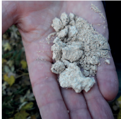
Abb. 11: Kalktuffprobe (Tab. 1, Quellhang Radegast) mit einem Kalkgehalt von 85 % (Foto: Hannappel, 09.11.2018) Calcareous tufa sample with lime content of 85 %
