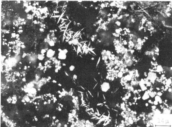
Abb. 15 :Neben idiomorpher Zinkblende (grau) kleine idiomorphe Pyrite (weiß) und Hämatit (grau-weiß, nadelig) , (Versuch 254).
