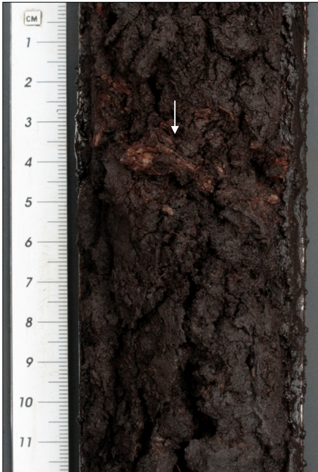
relativ häufig: Holzbeimengungen (Pfeil) in stark zersetzten Torfen; keine Klassifikation als Holztorf, da zu geringer Holzanteil (< 15 %)
