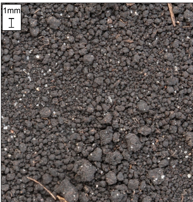
trockener vermulmter Torf: Bodenteilchen überwiegend deutlich < 1 mm, leicht ausblasbar, pulvrig-staubig; ähnlich Kohlengrus
