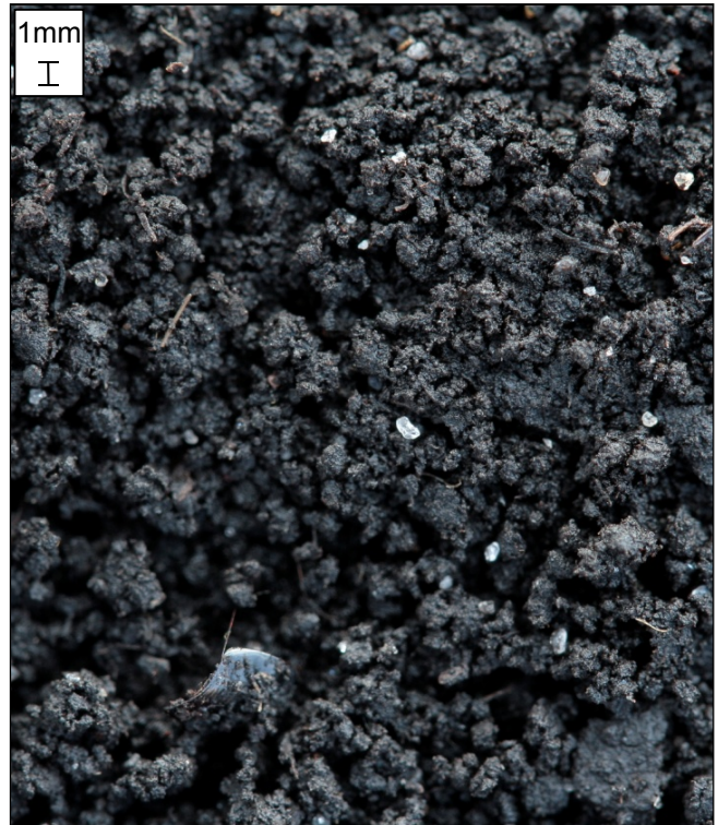
feuchter vermulmter Torf: feines, körniges Gefüge mit schmieriger Konsistenz
