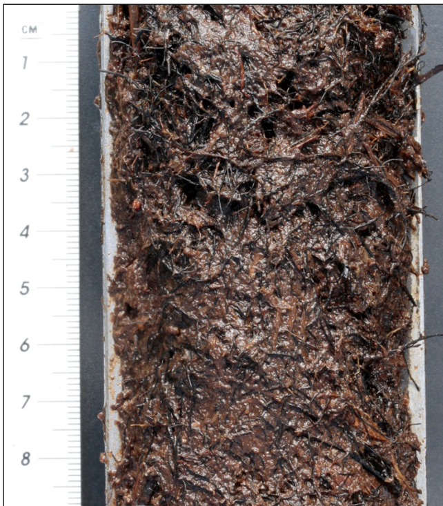
mäßig zersetzter Schachtelhalmtorf (H5); zahlreiche feine, schwarze Würzelchen des Schachtelhalms in brauner Grundmasse bereits im Bohrgerät sichtbar
