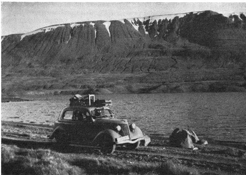
Abb. 12. In Island wurde ein Kleinwagen benutzt. Das Gravimeter hängt wie üblich federnd im Wagen, Stativ und Zelt sind auf dem Dach angeschnallt. Vordergrund: Ein guter Autoweg, dahinter der Ljósa-Vatn (= Lauter-See). Hintergrund: Der Storadalsfjall 800 m hoch, mit jüngerem Kar. Das Ljósavatn-Tal ist nicht tektonisch angelegt, es ist ein rein glaciales Trogtal. Tal und Plateauberge gehören einem gemeinsamen Plateaubasalthorst an.
