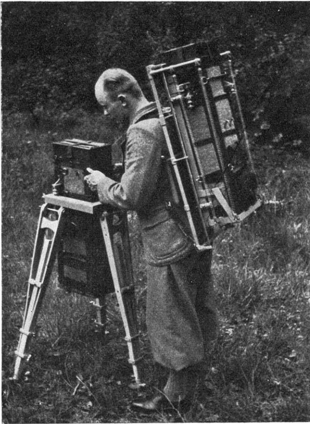
Abb. 8. Rückentrage. Das Gravimeter steht in einem federnd aufgehängten Schlitten.
