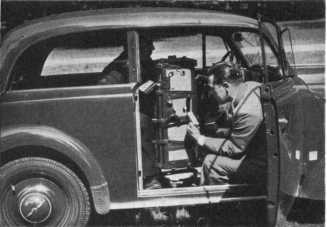
Abb. 11. Übliche Aufstellung des Thysen-Gravimeters im Meßwagen.
