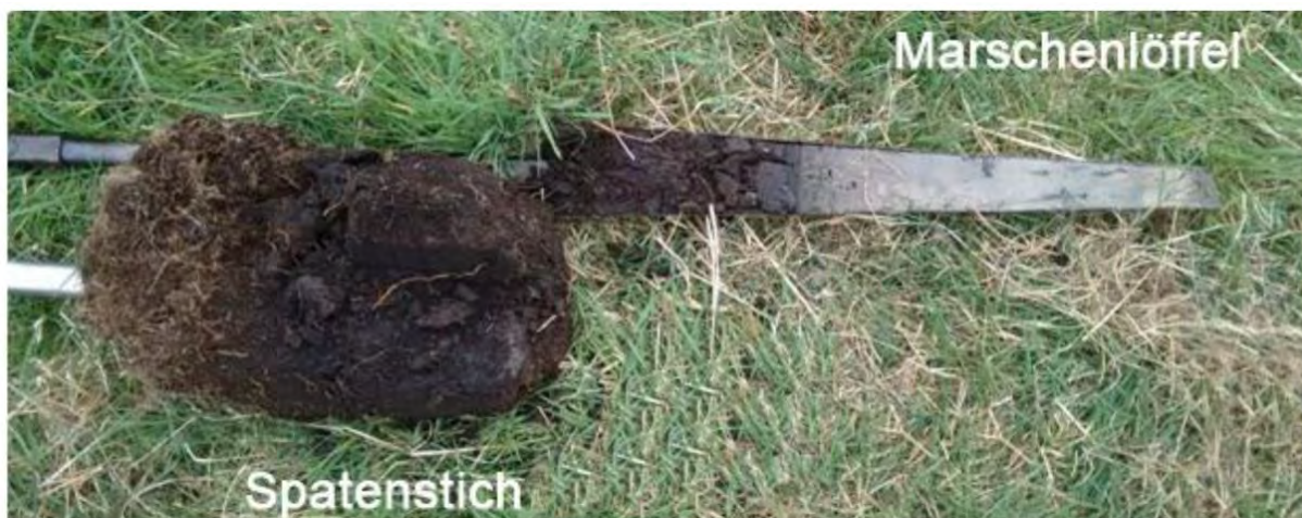
Abbildung 26: Bodenaufnahmen mit Spaten und Marschenlöffel (Heinsohn 2017)
