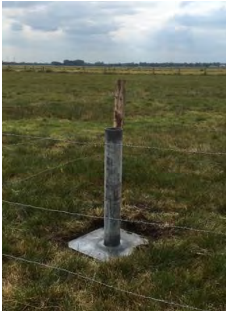
Abbildung 75: Metallreflektor zur Messungen von Höhenveränderungen der Mooroberfläche mittels Satellitendaten (SAR-Interferometrie)
