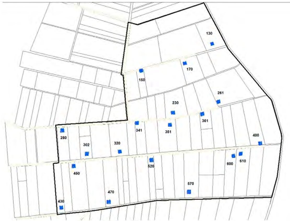
Abbildung 25: Lageplan der Dauerflächen zur Messung der Moormächtigkeiten (Heinsohn 2017)
