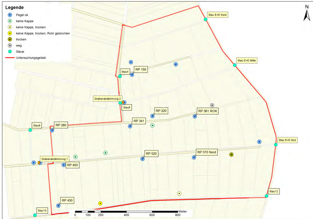
Abbildung 42: Lageplan aller Grundwassermessstellen und der Messstellen mit eingebauten Dataloggern (RP) sowie die Lage der aktuellen Stauanlagen
