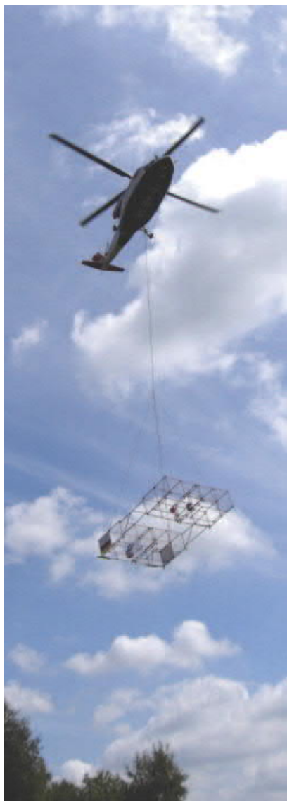
Abb. 7: Pulsradarsystem unter dem BGR-Hubschrauber. Foto: BGR
