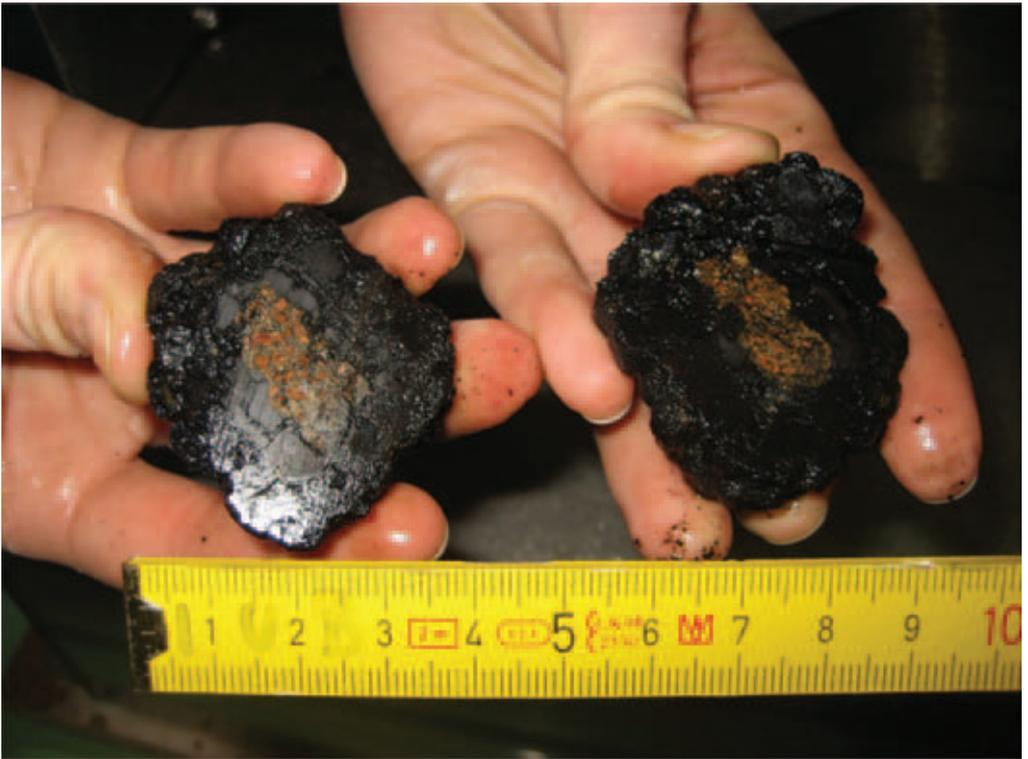
**Querschnitt durch eine Manganknolle aus der CCZ. Gut erkennbar ist der Nukleus im Zentrum der Knolle, um den Eisen- und Manganoxide in diskreten Wachstumslagen präzipitiert sind (Foto A. Koschinsky).**
