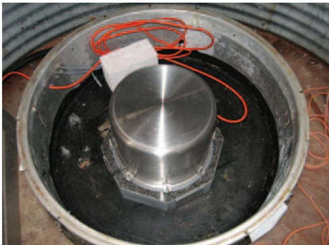
**Abb. 2:** Breitband-Seismometer vom Typ Streckeisen STS-2 (GRF-Array, Element C<sub>3</sub>). Das Instrument befindet sich in einem 4,45 m tiefen Schacht. Zur besseren Ankopplung an den Untergrund steht es auf einer Platte aus Gabbro.
