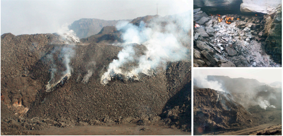
Abb. 1: Brennender Abraum im Gebiet um Wuda. Etwa 25 m Deckgestein wurden weggesprengt, um die brennende Kohle auszuräumen und das Feuer dadurch zum Stillstand zu bringen (Fotos: M. Wuttke).
