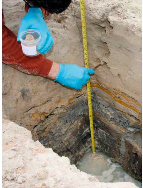
Abb. 3: Geomikrobiologische Probenahme an einem aufgetragenen Tiefenprofil einer Bergbauhalde aus Flotationsrückständen (mine tailings) der Kupfererzverarbeitung in Chile. Aufgrund mikrobieller Pyritoxidation kommt es zur Ausfällung von braunen Eisen(III)-oxid-hydraten.
