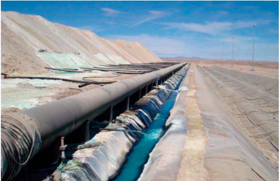
Abb. 6: Größte Haldenbiolaugung (Haldenvolumen: 5.000 \times 2.000 \times 126 \text{ m}^3 ) von Kupferarmerz aus dem Tagebau der Mine Escondida in der Atacama-Wüste im Norden von Chile. Luft wird in die Halde transportiert, um die mikrobielle Oxidation der Kupfersulfide zu beschleunigen. Im Drainagegraben wird die kupfersulfatreiche „pregnant leach solution“ aufgefangen und anschließend wird das Kupfer mittels Solvent-Extraktion und Elektrolyse (SX-EW) rein gewonnen (Foto: C. Demergasso).
