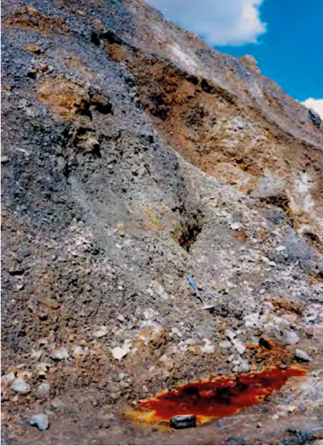
Abb. 2: „Acid mine drainage“ am Fuße einer sulfidischen Bergbauhalde in Bolivien aufgrund mikrobieller Pyritoxidation.
