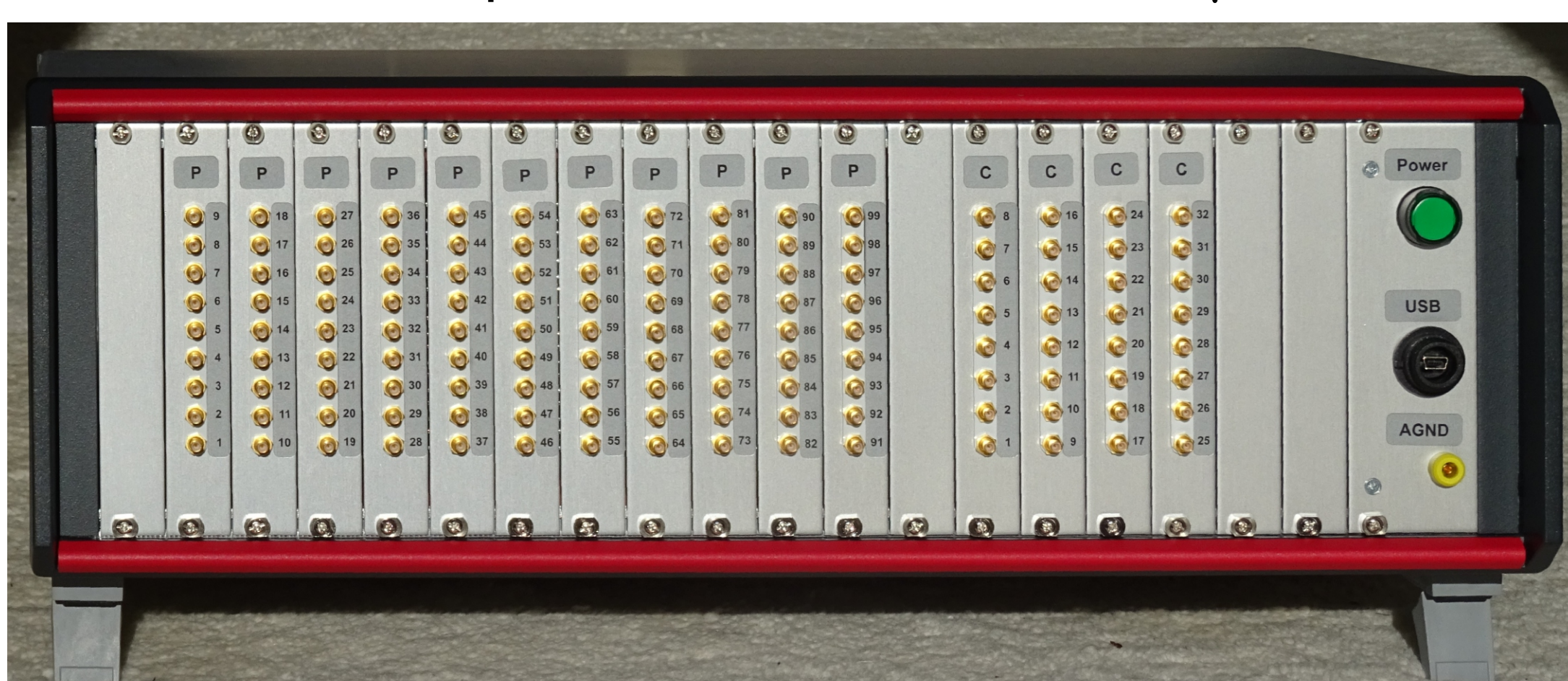
Abb. 2: SIP-Labor-Messinstrument für sequentielle mono- und schnelle multifrequente Impedanzmessungen. Es ermöglicht die gleichzeitige Impedanzmessung mit 88 4-Punkt Konfigurationen. Der Anregungsstrom kann in 2 von 32 Stromelektroden gespeist werden.
