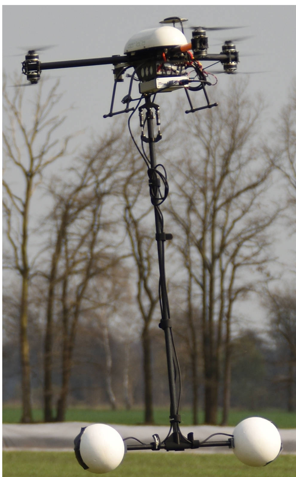
Abbildung 1: Das Messsystem, ein Hexakopter mit 1,5 kg Nutzlast im Flug. Die Gesamtmasse beträgt 5 kg bei einer Flugzeit von bis zu 15 Minuten. Der Sensorabstand beträgt 50 cm, die Länge des Auslegers beträgt 1,15 m.
