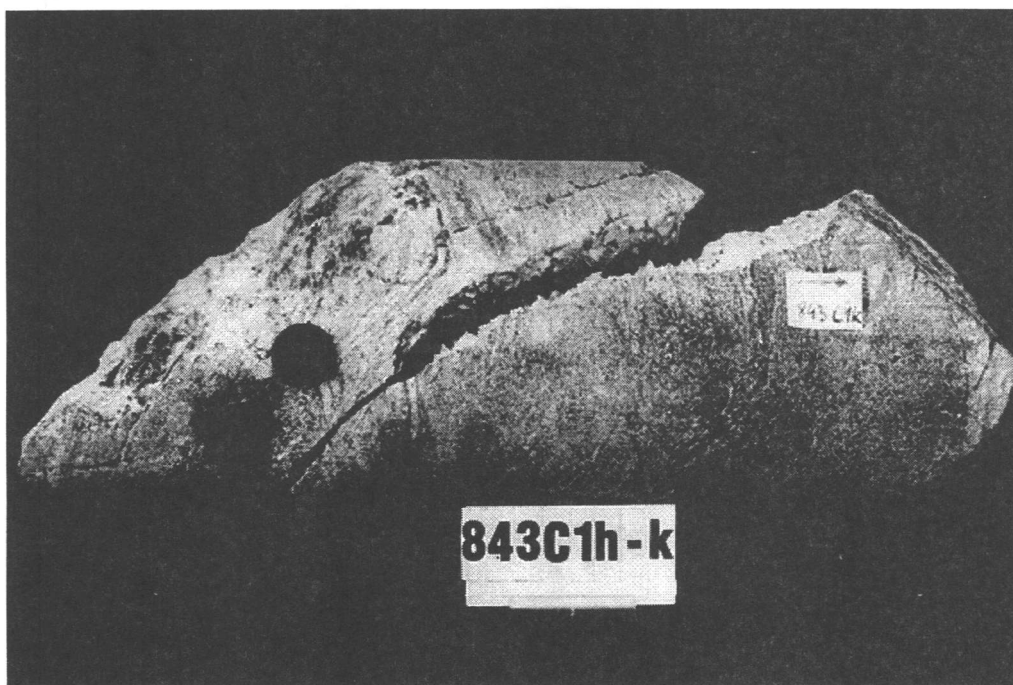
Abb.1: Kern mit offener Kluft (ca. 1 cm Öffnungsweite) aus einer Teufe von 3447 m
