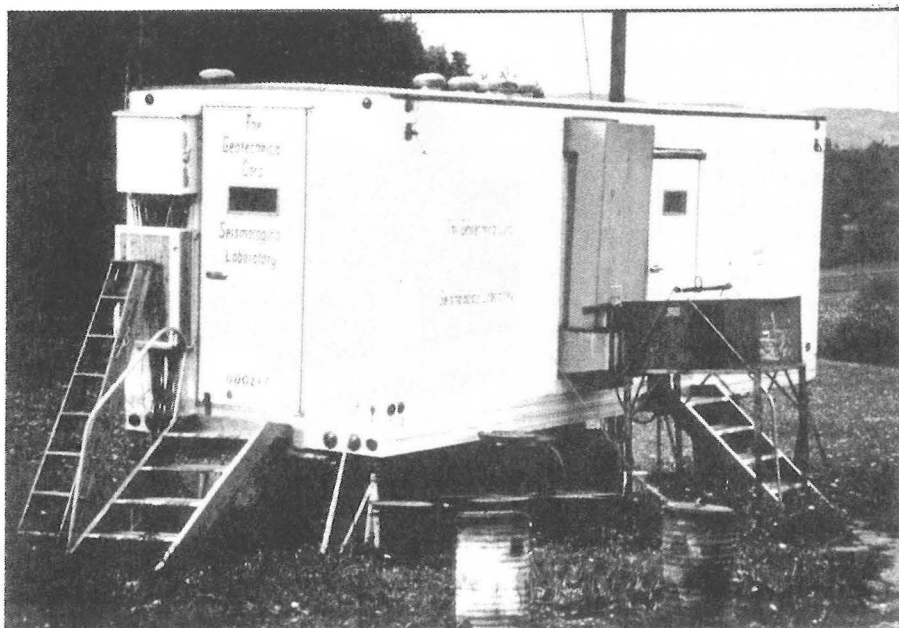
Abb. 2: Instrumenten-Container der LRSM-Station GRF nahe der Ortschaft Haidhof. Auf dem Gelände befinden sich heute die Referenzstation des GRF-Breitbandarray, eine ultra-langperiodische Station sowie eine Breitband-Bohrlochstation des globalen Stationsnetzes von Stationen mit IRIS-Standard.
