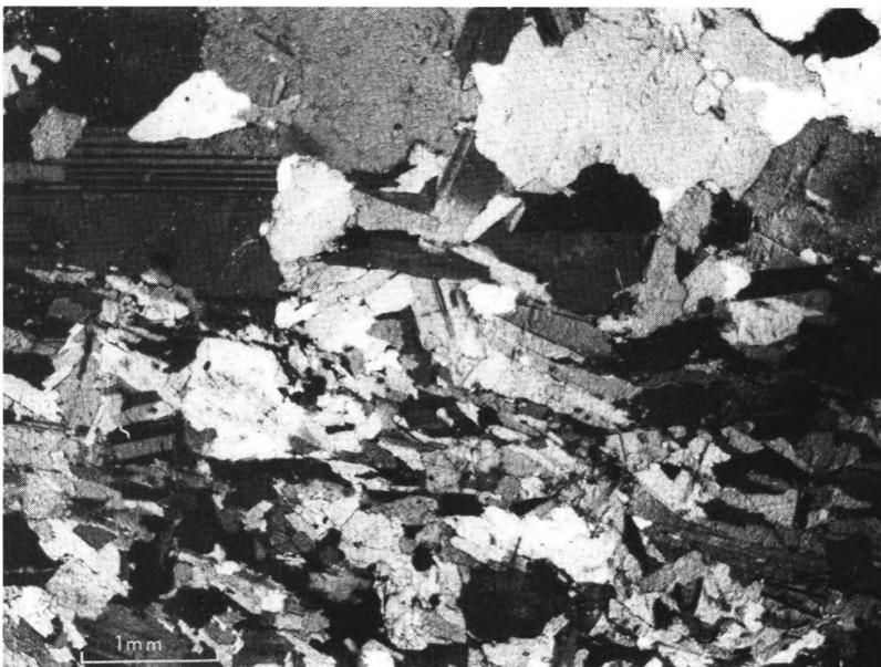
**Fig. 13:** Kontakt zwischen dem mittel- bis grobkörnigem JFG und einem fein- bis kleinkörnigem Quarzglimmerdiorit-Einschluß, P 15; +Nicols
