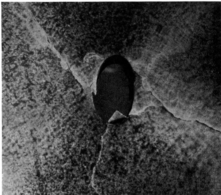
Abb. 25. Ovale Strecke unter Druck — Firste und Sohle geschont, Scherrisse, Ausbruchschalen in den Stößen.
