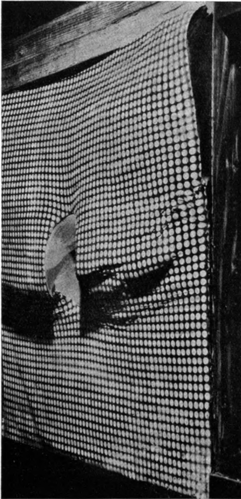
Abb. 26. Verformung einer ovalen, nur seitlich an der Ausdehnung behinderten Streckenöffnung bei Druckerhöhung
